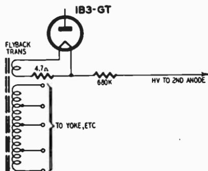
Fig. 1-R. HV rectifier circuit.
