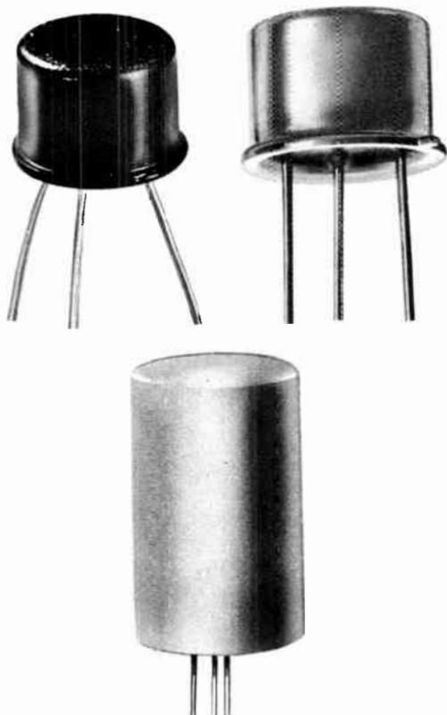
Fig. 1014. *Some transistor types.*
