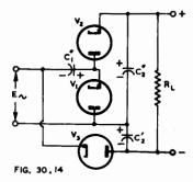
Fig. 30.14. Voltage tripler rectifier circuit.
