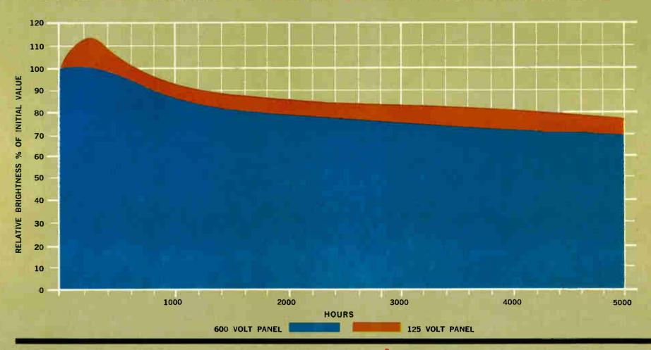
TYPICAL PERFORMANCE CURVES FOR PANELRAY LAMPS FOR 60 CPS OPERATION
