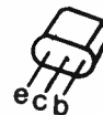
TR 201 (2SC1675) TR 202 (2SC1675) TR 401 (2SC2000) TR 402 (2SC1675) TR 403 (2SC1675) TR 901 (2SC945)
