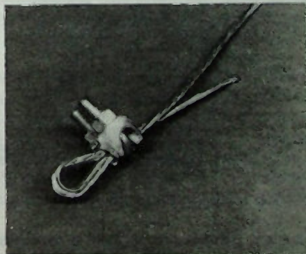
Fig. 10-6. Guy wire attachment technique.
