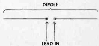
Fig. 36—Basic dipole antenna.
