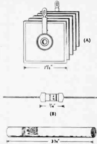
Fig. 24—(A) Selenium rectifier.
