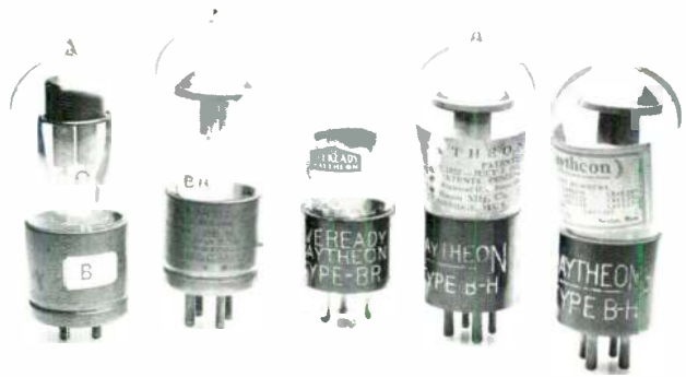
Raytheon gaseous rectifiers 1925–1927.
