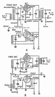
FIG. 612—CONVERTER CIRCUITS FOR THE 6L7
