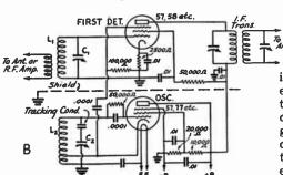
FIG. 610 — CONVERTER CIRCUITS EMPLOYING SUPPRESSOR-GRID INJECTION
