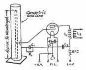
FIG. 1412 — A TYPICAL SINGLE-TUBE TRANS-MITTER WITH A CONCENTRIC GRID LINE
