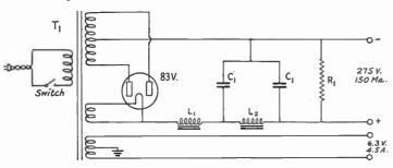
FIG. 1518 — A POWER PACK FOR SUPERHETERO-DYNE RECEIVERS, WITH SUFFICIENT RESERVE FOR SPEAKER FIELD SUPPLY
