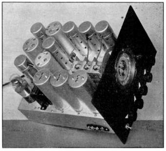
FIG. 726 - PANEL LAYOUT OF THE SEVEN-TUBE SUPERHET
