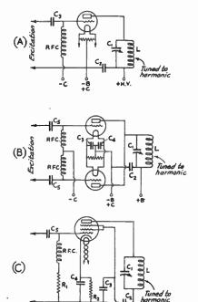
FIG. 823 — FREQUENCY MULTIPLYING CIRCUITS
