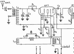
FIG. 711 — CIRCUIT DIAGRAM OF THE ADVANCED TWO-TUBE RECEIVER
