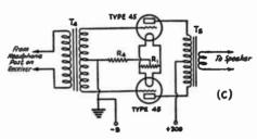
FIG. 606 — AUDIO POWER AMPLIFIERS FOR LOUD-SPEAKER OPERATION
