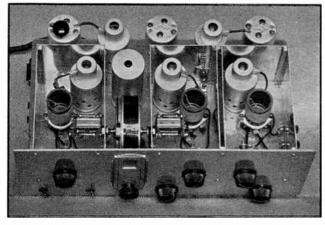
FIG. 721 — A SIX-TUBE REGENERATIVE SINGLE-SIGNAL SUPERHETERODYNE RECEIVER
