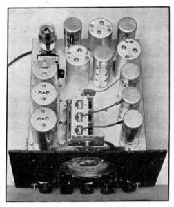
FIG. 725 — SEVEN-TUBE SUPERHETERODYNE WITH BAND-SWITCHING
