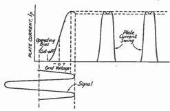
FIG. 510 -- CLASS-C AMPLIFIER OPERATION
