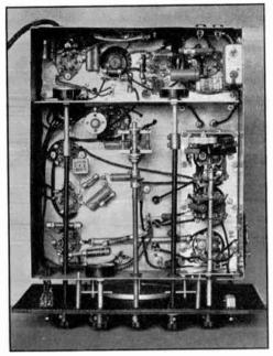
FIG. 727 — BOTTOM VIEW OF THE BAND-SWITCH-ING SUPERHETERODYNE
