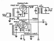
FIG. 611 — CONVERTER CIRCUIT FOR SCREEN-GRID INJECTION
