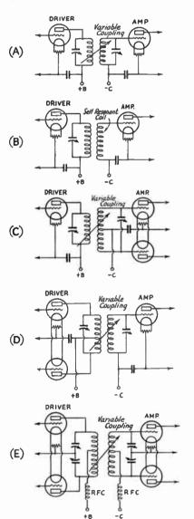
FIG. 815 -- INDUCTIVE INTERSTAGE COUPLING
