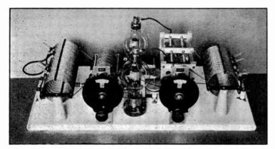
FIG. 923 - A PUSH-PULL AMPLIFIER FOR 50T'S OR 800'S
