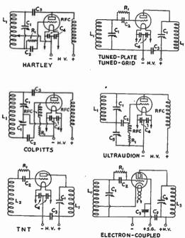
FIG. 801 — SELF-CONTROLLED OSCILLATOR CIRCUITS
