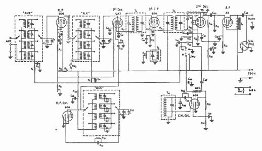
FIG. 728 - CIRCUIT DIAGRAM OF THE 7-TUBE SUPER
