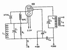
FIG. 909 - CIRCUIT OF THE SINGLE-TUBE CRYSTAL TRANSMITTER
