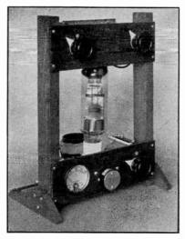
FIG. 911 — AN RK-20 TRI-TET OSCILLATOR
