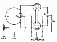
FIG. 1401 — A SIMPLE 56-MC. OSCILLATOR CIRCUIT
