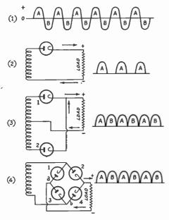
FIG. 1501 — FUNDAMENTAL RECTIFIER CIRCUITS
