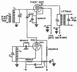
FIG. 608 — SUPERHET CONVERTER CIRCUIT US-ING AN ELECTRON-COUPLED OSCILLATOR AND CONTROL-GRID INJECTION
