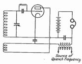
FIG. 514 — AN ELEMENTARY SUPERREGENERATIVE CIRCUIT
