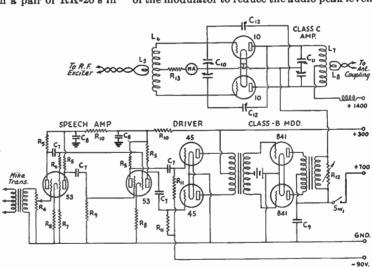
FIG. 1210 — CLASS-B CONTROLLED-CARRIER CIRCUIT FOR 500-VOLT TYPE TUBES (W2CTK)
