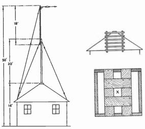
FIG. 1804 — ANTENNA MAST ON TOP OF A TWO-CAR GARAGE
