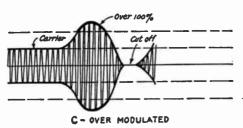
FIG. 1102 — GRAPHICAL REPRESENTATION OF THE AMPLITUDE MODULATED WAVE
