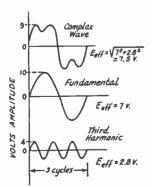
FIG. 307 — A COMPLEX WAVE AND ITS SINE-WAVE COMPONENTS
