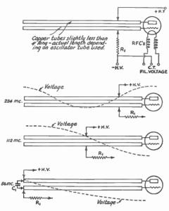
FIG. 1405 — A THREE-BAND ULTRA-HIGH-FREQUENCY TRANSMITTER
