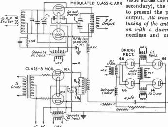
FIG. 1211 — CONTROLLED-CARRIER CIRCUIT FOR 1000-VOLT TUBES (W2HLM)
