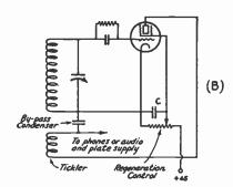
FIG. 603 — METHODS OF CONTROLLING REGENERATION
