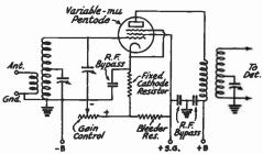
FIG. 604 — A TYPICAL RADIO-FREQUENCY AM-PLIFIER CIRCUIT WITH BIAS GAIN CONTROL
