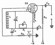
FIG. 1709 — SIMPLE 'PHONE MONITOR USING A
