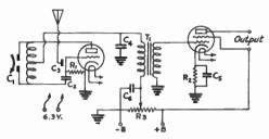
FIG. 1303 — CIRCUIT OF THE SIMPLE THREE-BAND RECEIVER
