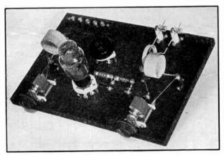
FIG. 908 — A SIMPLE CRYSTAL OSCILLATOR SUITABLE FOR LOW-POWER WORK
