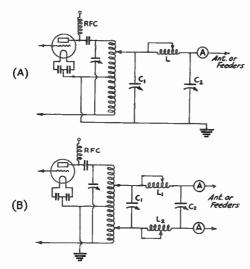
FIG. 829 - ANTENNA-COUPLING FILTERS
