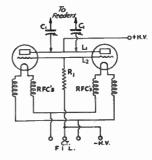
FIG. 1404 — A PUSH-PULL VERSION OF THE LINEAR OSCILLATOR
