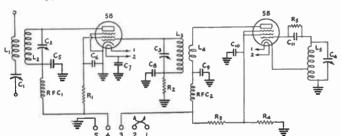
FIG. 1417 - CIRCUIT DIAGRAM OF THE LOW-POWER OSCILLATOR-AMPLIFIER TRANSMITTER
