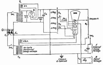
FIG. 1717 — A PRACTICAL OSCILLOSCOPE CIRCUIT
