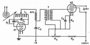
FIG. 1301 — A SIMPLE SELF-QUENCHED SUPERREGENERATIVE RECEIVER
