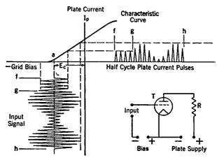
Fig. 11-29. Triode Rectification.
