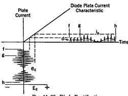
Fig. 11-28. Diode Rectification
