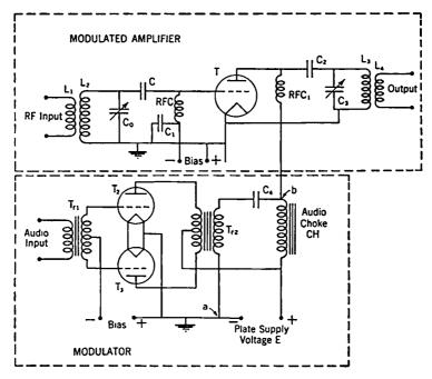
Fig. 12-5. Plate Modulation.
