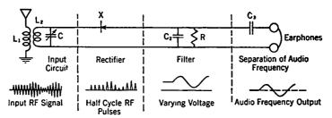
Fig. 11-26. Simple Crystal Detector.
