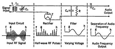
Fig. 11-27. Diode Detector.
