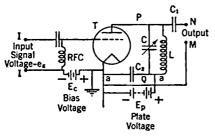
Fig. 11-4. Simple Triode Radio Amplifier.
