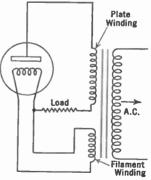
Fig. 249.—Tungar rectifier circuit.
