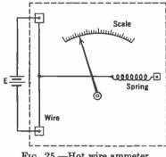
Fig. 25.—Hot wire ammeter.
