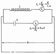
Fig. 95.—An anti-resonant circuit.
