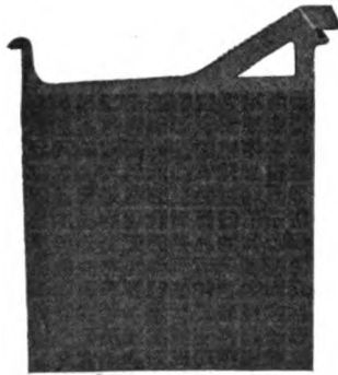
FIG. 14.—“Box” Negative Plate.
