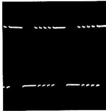
Photo 5. — Signal rectangulaire 1500 Hz wobbulé par un signal rectangulaire à 150 Hz.
