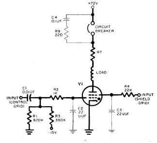
PLATE LOADED CIRCUIT 2
