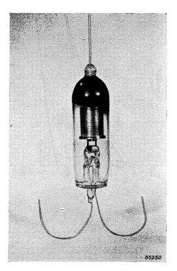
Fig. 1 The E.H.T. rectifier EY 51 (about actual size).
