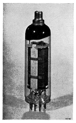
Fig. 1 The line-output pentode PL 81 (about actual size).
