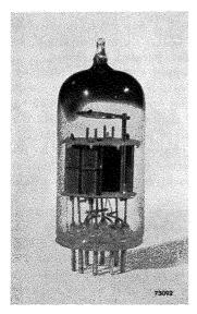
Fig. 1 The double triode ECC 81 (about actual size).
