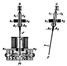
Fig. 49.—Construction of Pendulum Rectifier.
