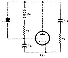
PLATE-TO-GRID CRYSTAL CONNECTION
