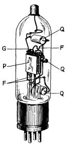
FIG. 109.—Pliotron detector tube (FP-54).
