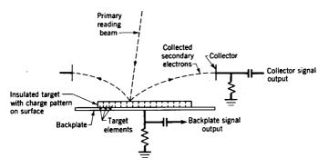
Fig. 10. Capacity-discharge reading system.
