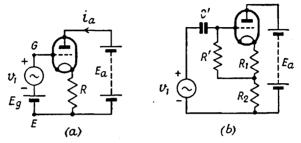
FIG. 83. BIASING CIRCUITS FOR CATHODE FOLLOWER
