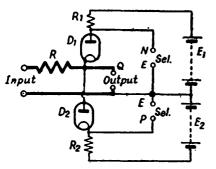
FIG. 200. TIME SELECTION BY BALANCED DIODES
