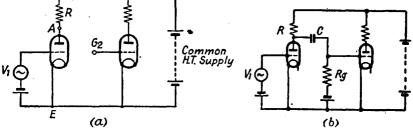
FIG. 29. RESISTANCE-CAPACITANCE COUPLING
