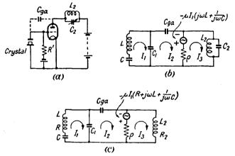
FIG. 107. PIERCE-MILLER CRYSTAL OSCILLATOR AND EQUIVALENT CIRCUITS
