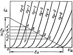
FIG. 20. LOAD-LINE DIAGRAM
