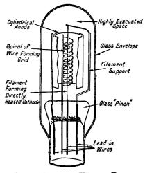
FIG. 4. DIRECTLY HEATED TRIODE
