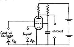
FIG. 195. TIME SELECTION ("COINCIDENCE CIRCUIT")
