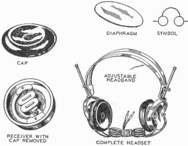
**ELECTROMAGNETIC TELEPHONE HEADSET FOR RADIO USE**
