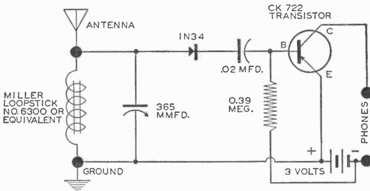
**SCHEMATIC CIRCUIT DIAGRAM OF THE COMBINATION CRYSTAL DIODE AND TRANSISTOR RADIO RECEIVER**
