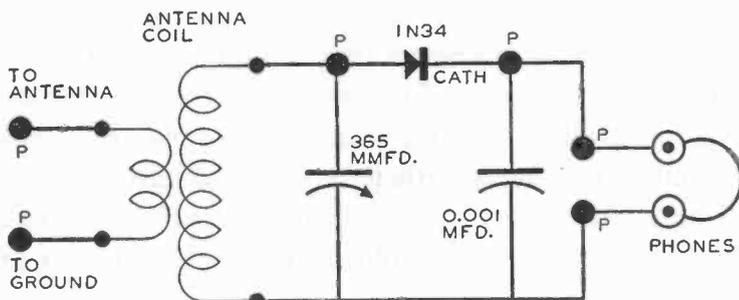
**DIAGRAM OF CIRCUIT OF SIMPLE CRYSTAL RECEIVER**
