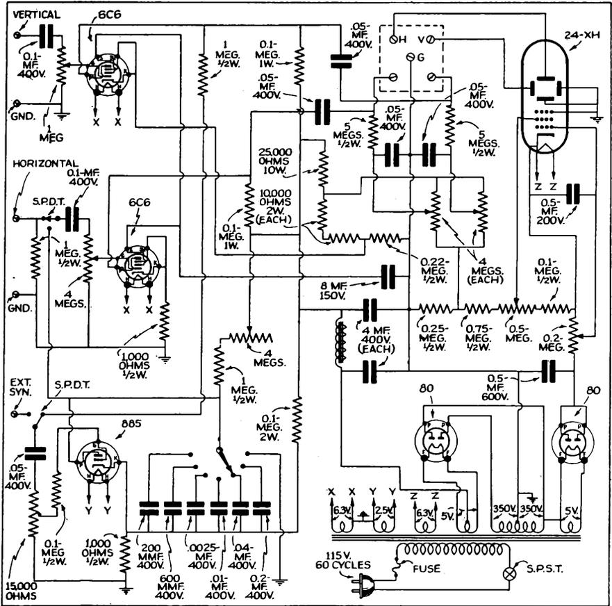
Fig. 28. Dumont 2" Oscilloscope
