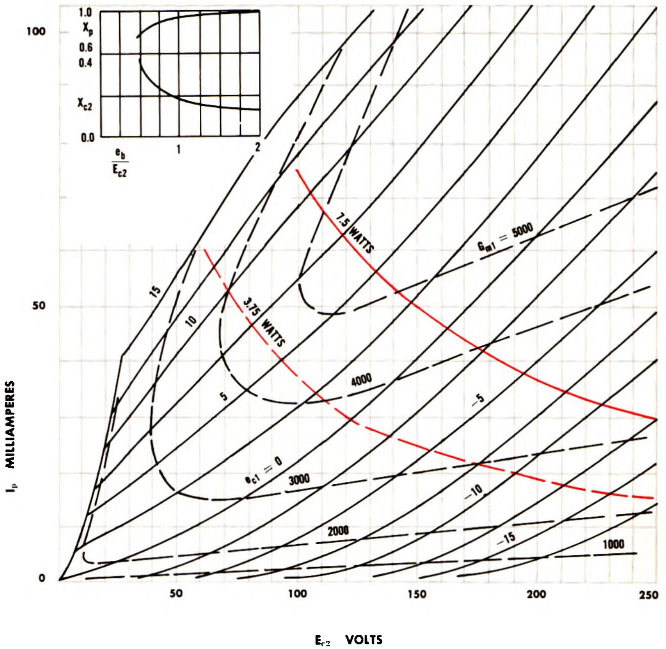
$P_p$  7.5 WATTS:  $P_{c2}$  3.0 WATTS
