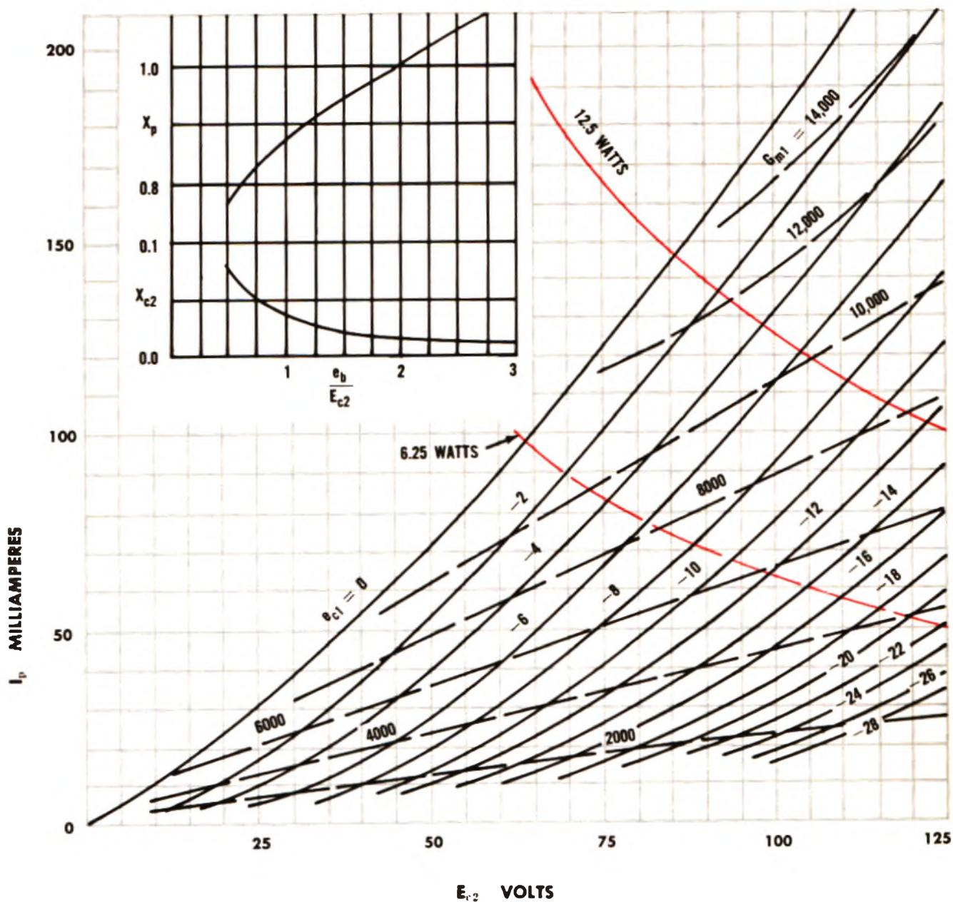
$P_p$  12.5 WATTS:  $P_{c2}$  1.75 WATTS
