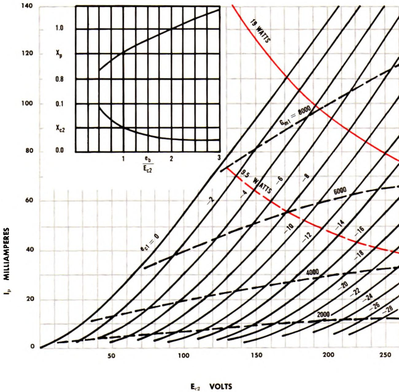
$P_p$  19 WATTS:  $P_{c2}$  2.5 WATTS
