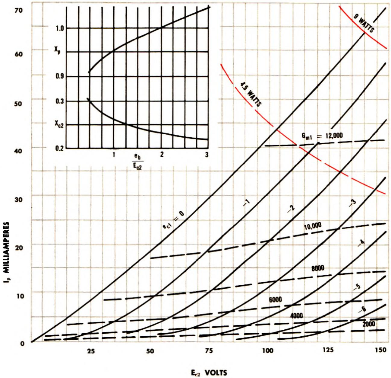
$P_p$  9.0 WATTS:  $P_{c2}$  1.5 WATTS
