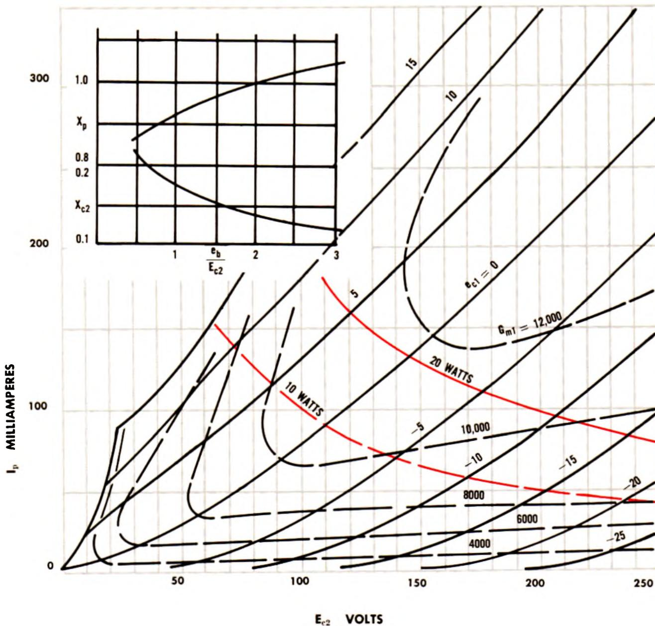
$P_p$  20 WATTS:  $P_{c2}$  7 WATTS TOTAL
