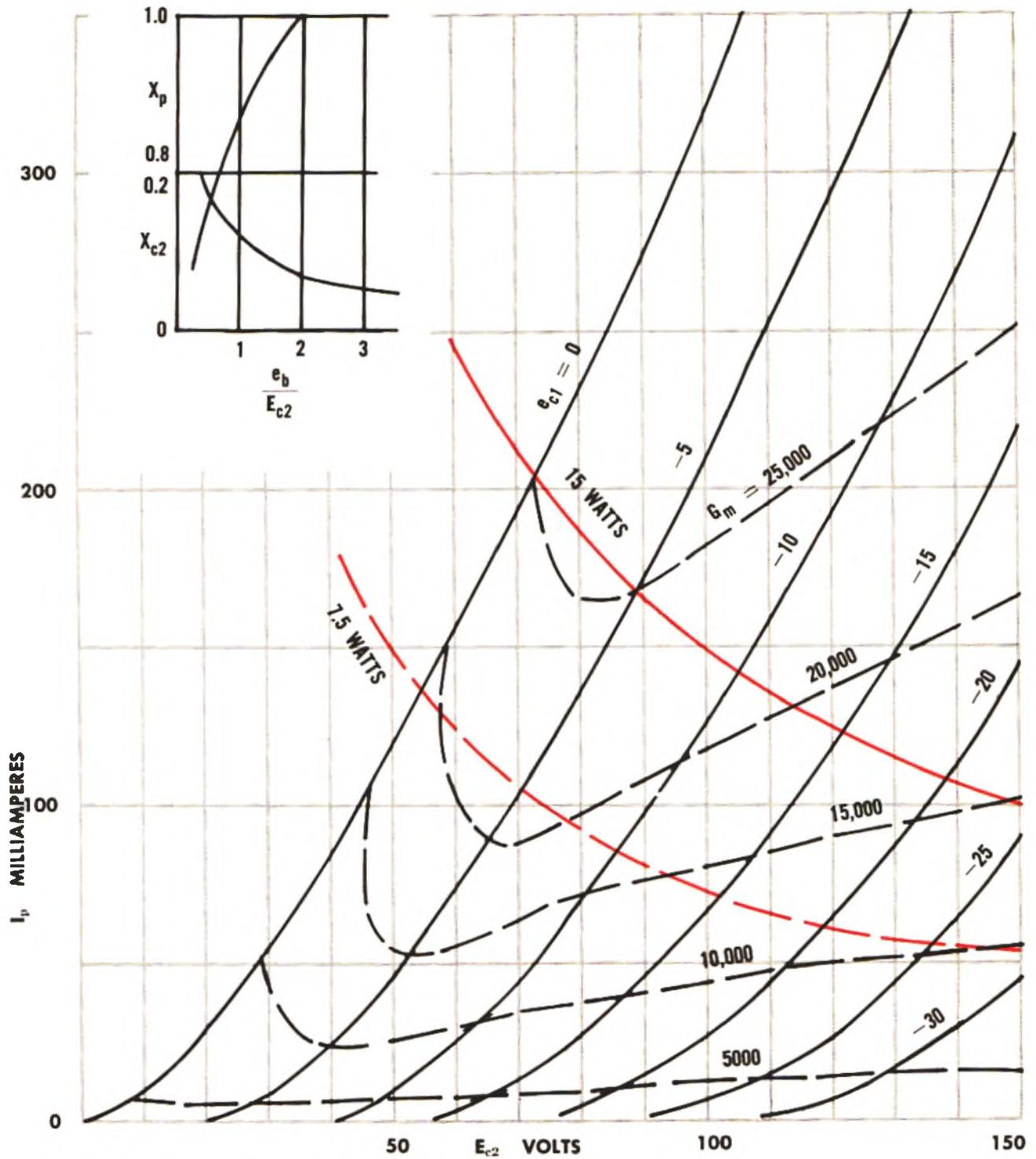
$P_p$  15 WATTS:  $P_{c2}$  3 WATTS
