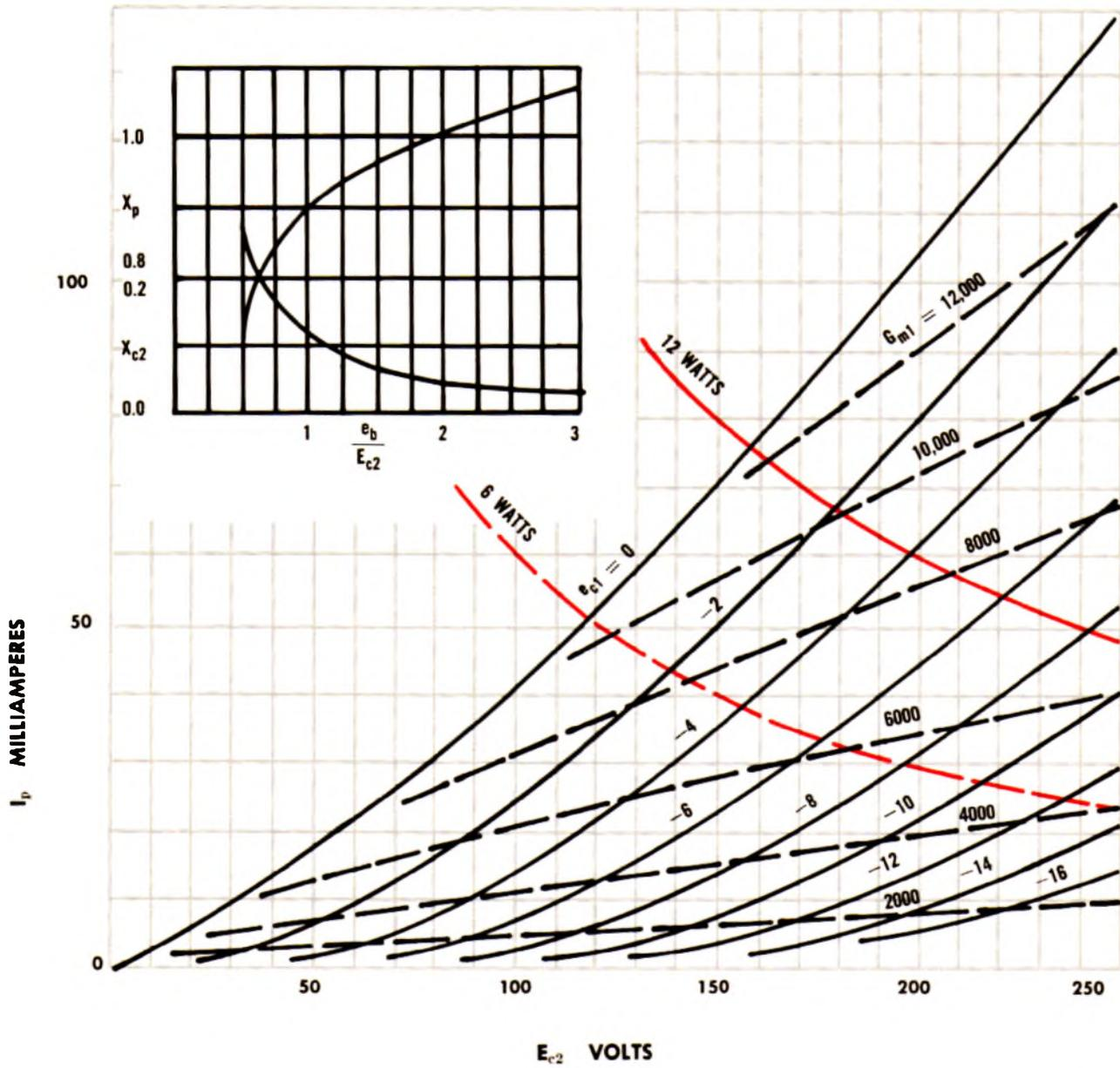
$P_p$  12 WATTS:  $P_{c2}$  2 WATTS
