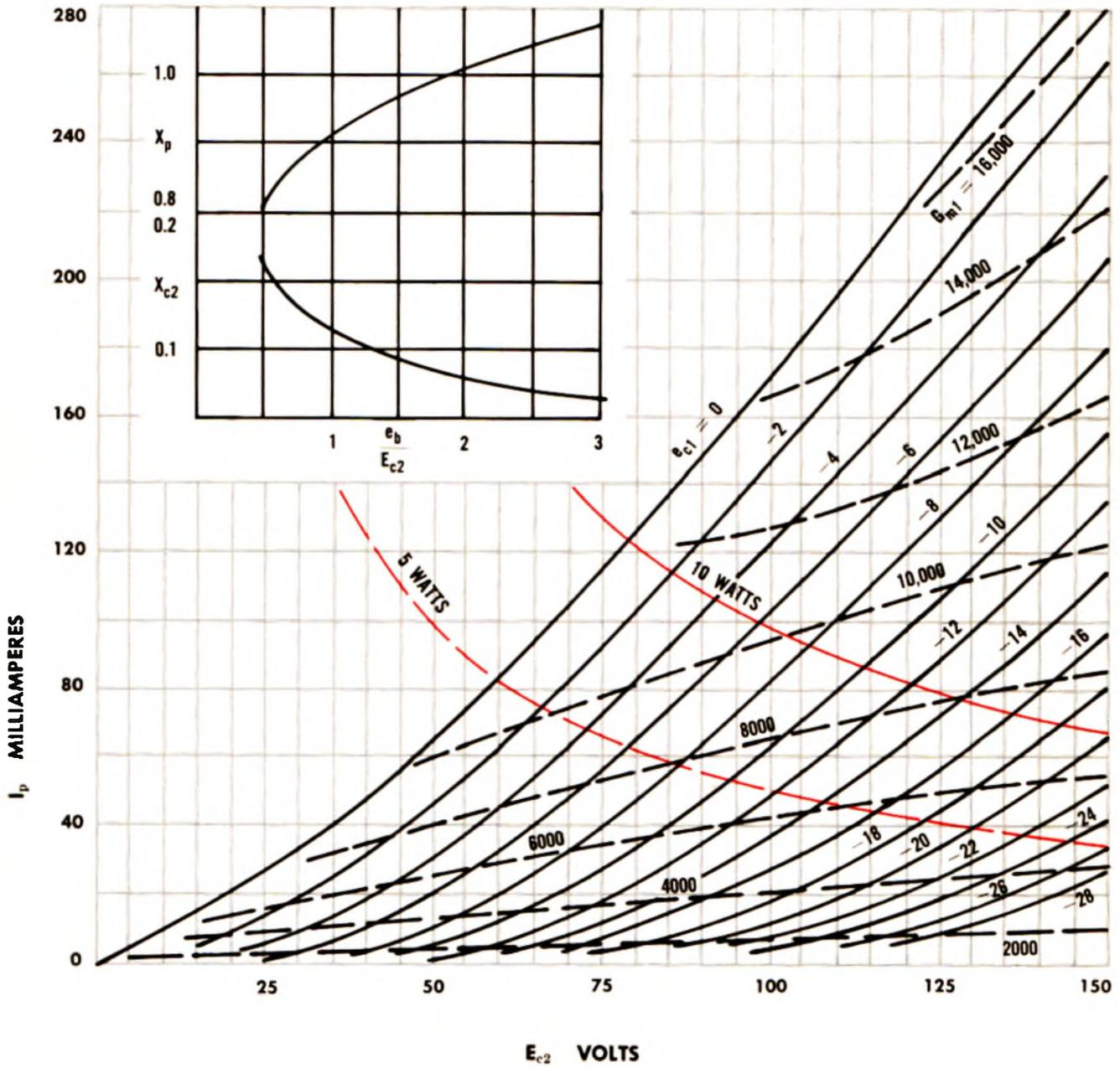
$P_p$  10 WATTS:  $P_{c2}$  2.5 WATTS
