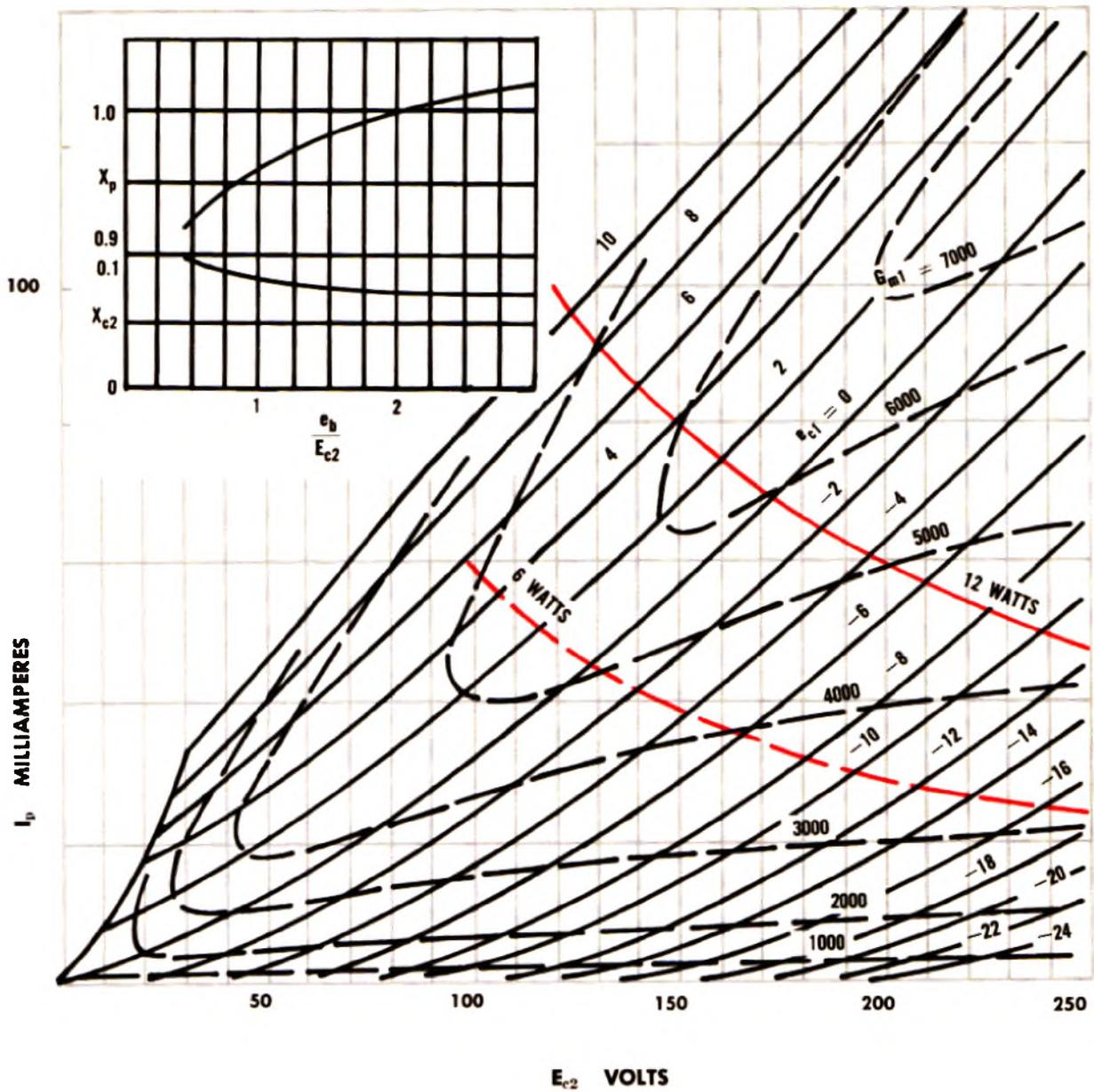
$P_p$  12 WATTS:  $P_{c2}$  2 WATTS
