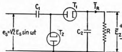
FIG. 4.5.—Half-wave-voltage-doubling rectifier.
