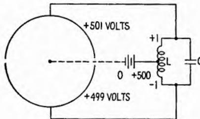
FIG. 13.10.—Split-anode magnetron.
