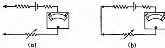
FIG. 3.1.—Series-type ohmmeter circuit.
