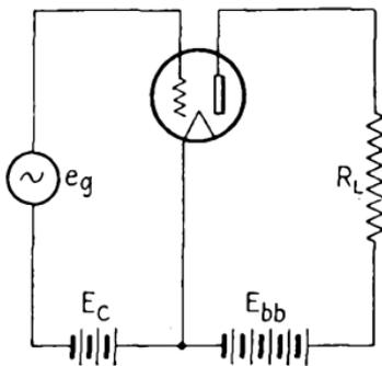
FIG. 19.—Triode circuit.
