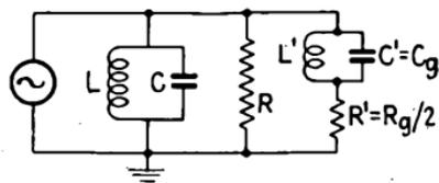
FIG. 110.—Equivalent h.f. circuit for actual diode circuit.
