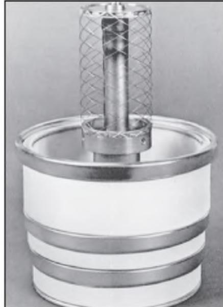
**Figure 3.27** Mesh tungsten filament.
