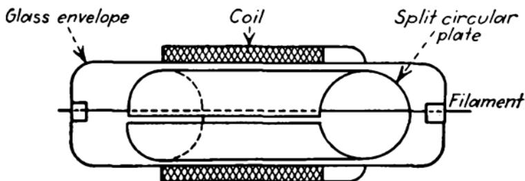
FIG. 188.—Diagram of magnetron.
