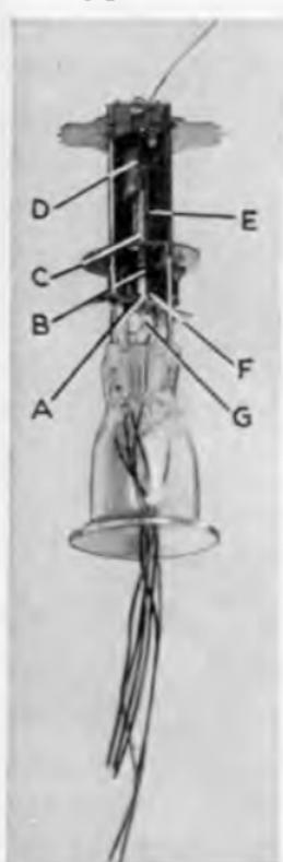
FIG. 82.—Duplex-diode triode.
