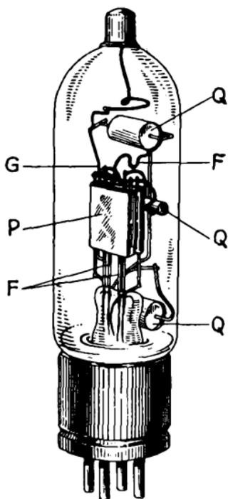
FIG. 109.—Pliotron detector tube (FP-54).
