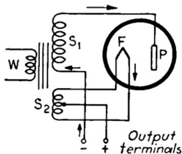
FIG. 286.—Simple rectifier circuit.
