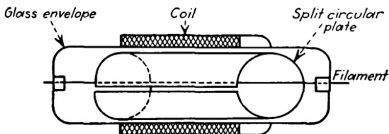
FIG. 188.—Diagram of magnetron.
