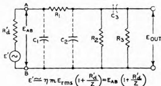
FIG. 27.8 EQUIVALENT DIODE CIRCUIT AT AUDIO FREQUENCIES.
