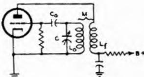
FIG. 24.3 TUNED-GRID OSCILLATOR
