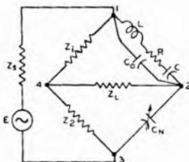
FIG. 26.11 CIRCUIT ARRANGEMENT FOR VARYING  $C'$  ( $= C_0 - C_N$ )
