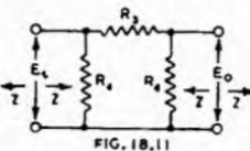
Fig. 18.11. Constant impedance  $\Pi$  section attenuator.
