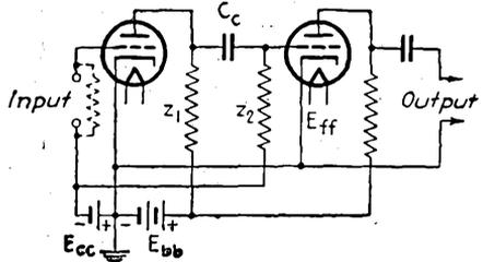
FIG. 5-6.—Impedance-capacitance-coupled amplifier.
