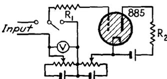
FIG. 15-21.—Slide-back voltmeter using a type 885 thyratron.
