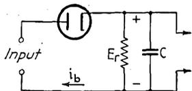
FIG. 9-24.—Diode detector circuit.
