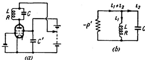
FIG. 104. DYNATRON OSCILLATOR
