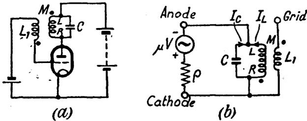
FIG. 93. TUNED-ANODE OSCILLATOR
