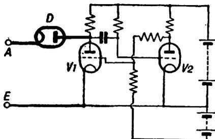
FIG. 197. DIODE SWITCH FOR TRIGGERING MONOSTABLE MULTIVIBRATOR
