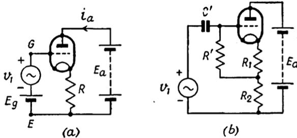
FIG. 83. BIASING CIRCUITS FOR CATHODE FOLLOWER
