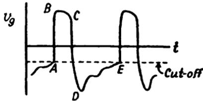
FIG. 179. GRID-VOLTAGE WAVEFORM OF BLOCKING OSCILLATOR
