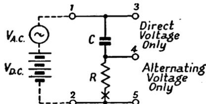
FIG. 27. A.C./D.C. SEPARATING CIRCUIT
