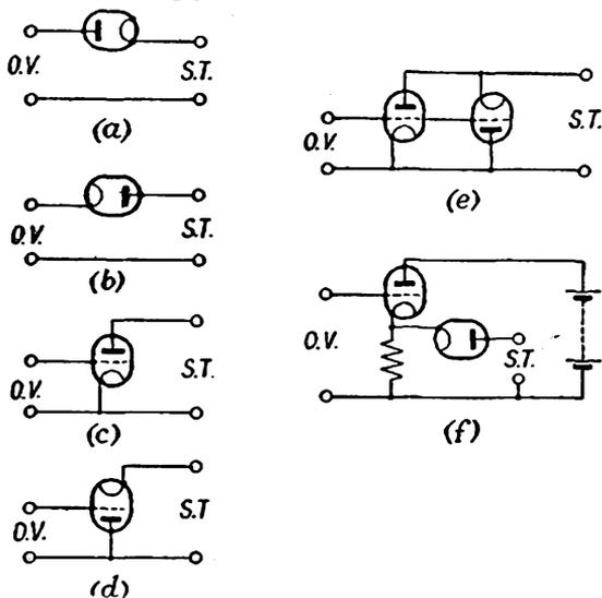
FIG. 196. ELECTRONIC SWITCH CIRCUITS
