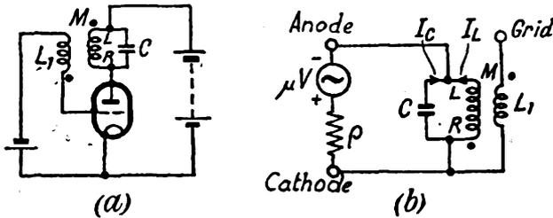
FIG. 93. TUNED-ANODE OSCILLATOR
