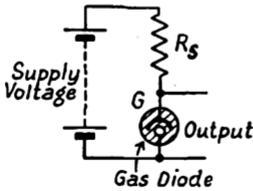
FIG. 84. SIMPLE VOLTAGE STABILIZER
