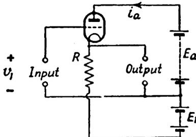
FIG. 194. CATHODE FOLLOWER AS AMPLITUDE SELECTOR
