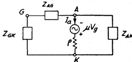
FIG. 97. PRINCIPLE OF CLOSED-CIRCUIT OSCILLATORS
