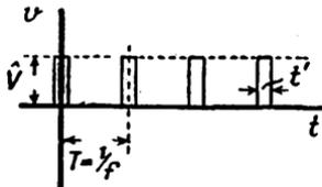
FIG. 169. RECTANGULAR PULSE WAVEFORM
