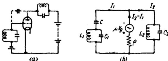
FIG. 103. TUNED-ANODE TUNED-GRID OSCILLATOR
