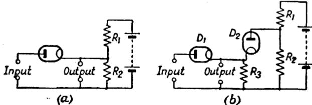
FIG. 191. STABILIZATION OF REFERENCE LEVEL AGAINST VARIATION OF CATHODE TEMPERATURE
