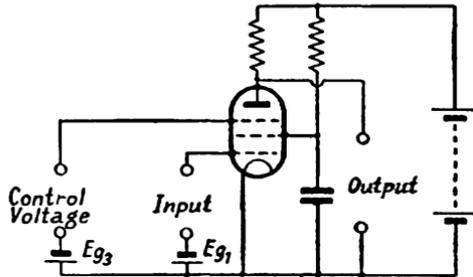
FIG. 195. TIME SELECTION ("COINCIDENCE CIRCUIT")
