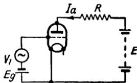
FIG. 19. BASIC AMPLIFIER CIRCUIT
