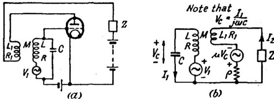
FIG. 95. TUNED-GRID REGENERATIVE AMPLIFIER
