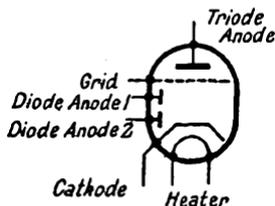
FIG. 138. DOUBLE-DIODE TRIODE
