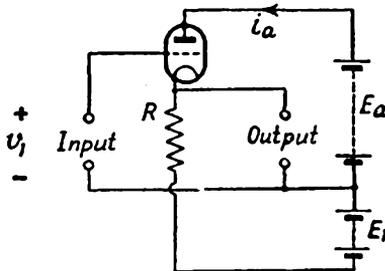
FIG. 194. CATHODE FOLLOWER AS AMPLITUDE SELECTOR
