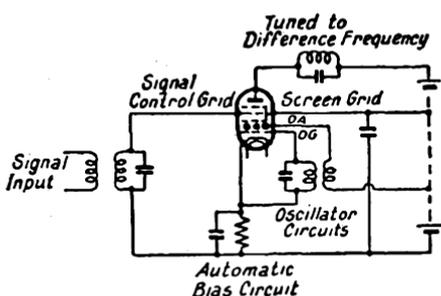
FIG. 161. THE PENTAGRID FREQUENCY CHANGER
