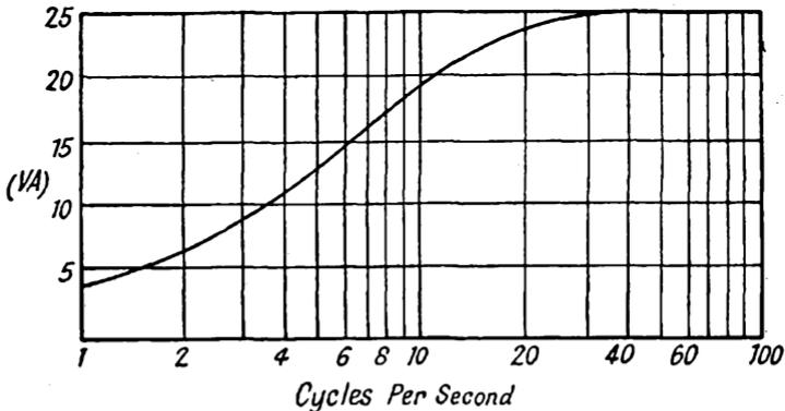
FIG. 31. FREQUENCY DISTORTION IN RESISTANCE-CAPACITANCE COUPLED AMPLIFIER STAGE HAVING—
