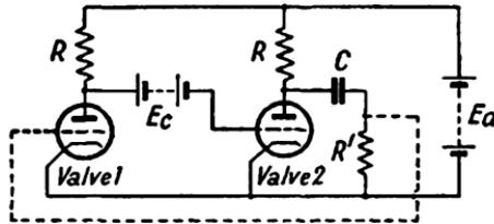
FIG. 118. FLIP-FLOP CIRCUIT
