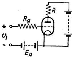
FIG. 187. SIMPLE SHAPING CIRCUIT
