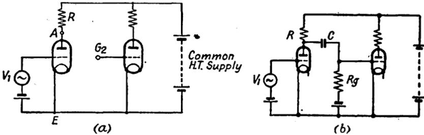
FIG. 29. RESISTANCE-CAPACITANCE COUPLING
