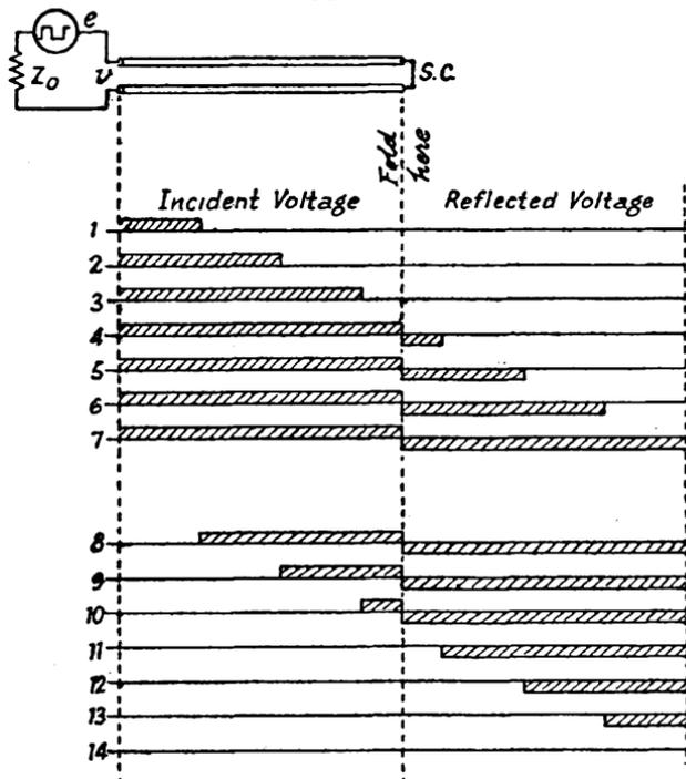
FIG. 181. SHORT-CIRCUITED DELAY LINE AS PULSE GENERATOR
