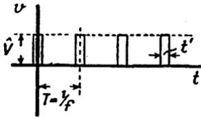
FIG. 169. RECTANGULAR PULSE WAVEFORM
