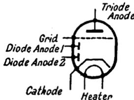
FIG. 138. DOUBLE-DIODE TRIODE
