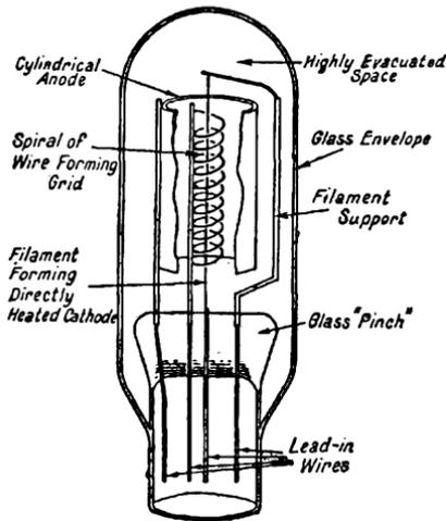
FIG. 4. DIRECTLY HEATED TRIODE
