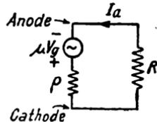
FIG. 26. EQUIVALENT ANODE CIRCUIT
