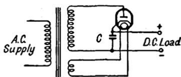
FIG. 139. HALF-WAVE RECTIFIER
