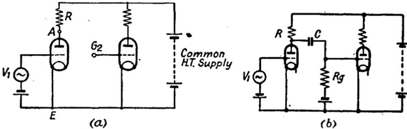
FIG. 29. RESISTANCE-CAPACITANCE COUPLING
