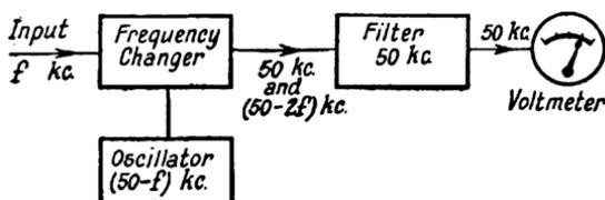
FIG. 168. HETERODYNE WAVE-ANALYSER
