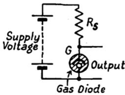
FIG. 84. SIMPLE VOLTAGE STABILIZER
