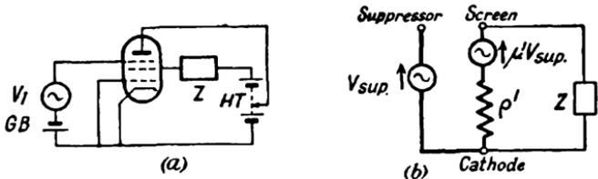
FIG. 110. PRINCIPLE OF TRANSISTRON-CONNEXION
