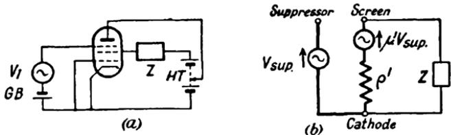
FIG. 110. PRINCIPLE OF TRANSISTRON-CONNEXION
