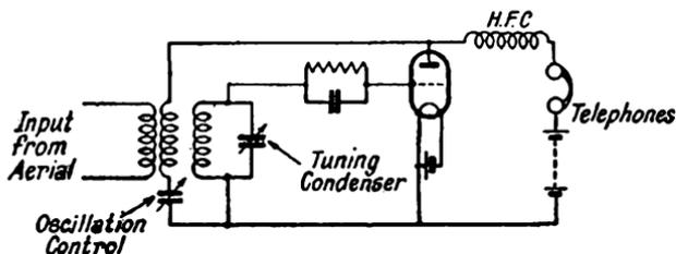
FIG. 166. THE AUTODYNE CIRCUIT
