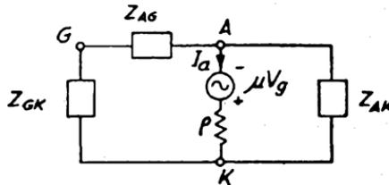
FIG. 97. PRINCIPLE OF CLOSED-CIRCUIT OSCILLATORS
