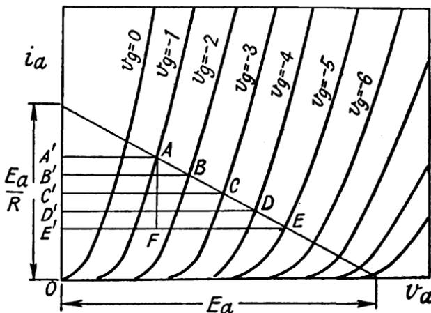
FIG. 20. LOAD-LINE DIAGRAM
