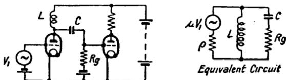
FIG. 33 CHOKE-CAPACITANCE COUPLING
