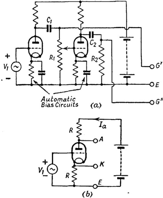
FIG. 49. PHASE INVERTERS
