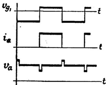
FIG. 183. DELAY-LINE PULSE GENERATOR WAVEFORMS
