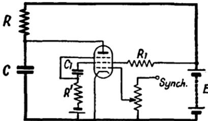
FIG. 126. TRANSATRON TIME-BASE
