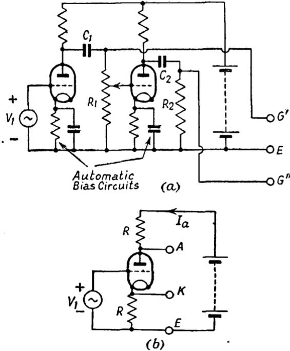
FIG. 49. PHASE INVERTERS
