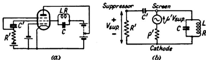
FIG. 111. TRANSITRON OSCILLATOR
