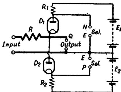
FIG. 200. TIME SELECTION BY BALANCED DIODES
