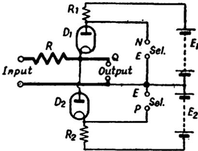
FIG. 200. TIME SELECTION BY BALANCED DIODES
