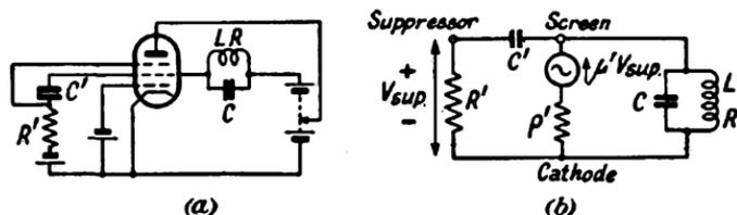
FIG. 111. TRANSITRON OSCILLATOR
