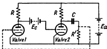
FIG. 118. FLIP-FLOP CIRCUIT
