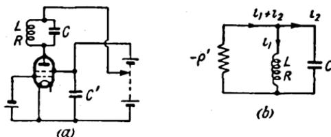
FIG. 104. DYNATRON OSCILLATOR
