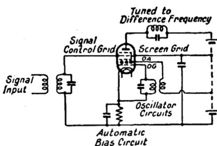
FIG. 161. THE PENTAGRID FREQUENCY CHANGER
