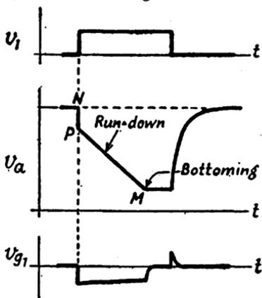
FIG. 219. WAVEFORMS OCCURRING IN MILLER SWEEP CIRCUIT OF FIG. 218 (d)
