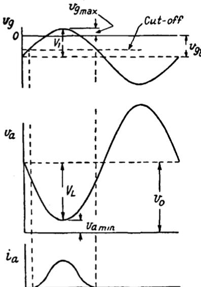
FIG. 92. OPERATION DIAGRAM FOR CLASS C AMPLIFIER
