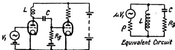
FIG. 33 CHOKE-CAPACITANCE COUPLING
