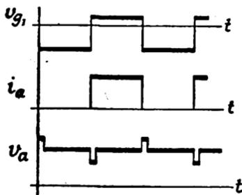
FIG. 183. DELAY-LINE PULSE GENERATOR WAVEFORMS
