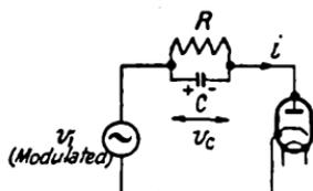
Fig. 127. DIODE DETECTOR
