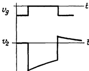
FIG. 206. DISTORTION OF PULSE WAVEFORM BY  $R-C$  COUPLING
