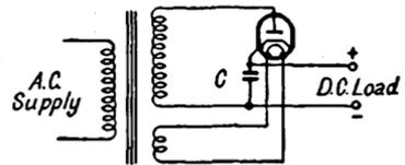
FIG. 139. HALF-WAVE RECTIFIER
