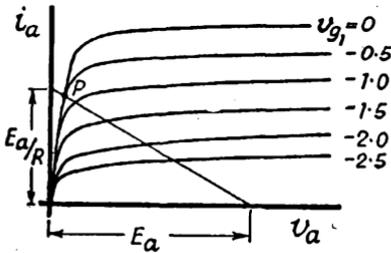
FIG. 192. BOTTOMING IN A PENTODE CIRCUIT
