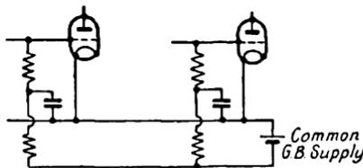
FIG. 45. GRID-BIAS DECOUPLING
