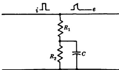
FIG. 3-2.—Decoupling circuit.
