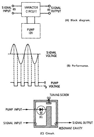
Fig. 5-4. Principle of the parameter amplifier.
