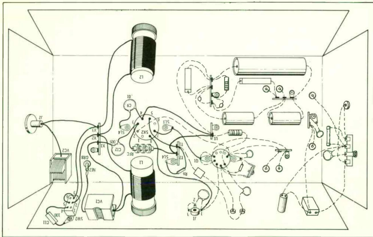
Fig. 6-7. Wiring the amplifier.
