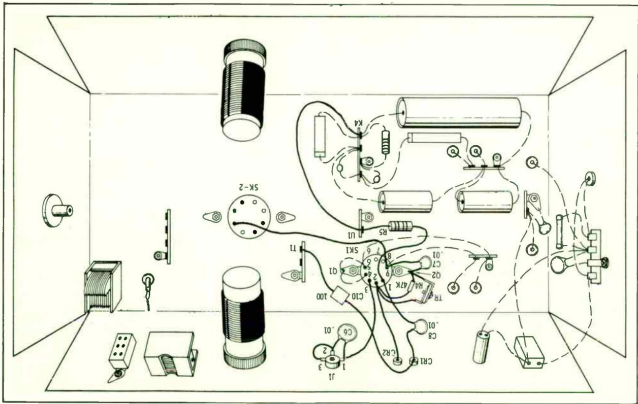
Fig. 6-6. Wiring the oscillator.
