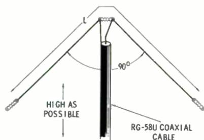
Fig. 10-6. Inverted V antenna.
