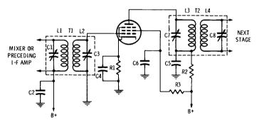
Fig. 4-21. A pentode i-f circuit.
