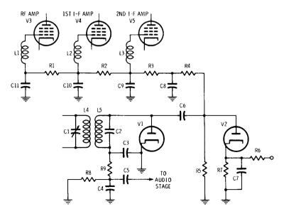
Fig. 4-28. An automatic-volume-control circuit.
