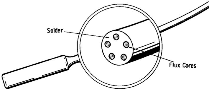
**Fig. 2-8. Multicore solder.**
