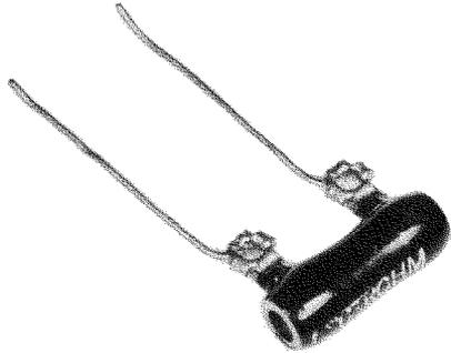
Fig. 3-2. Fixed wirewound resistor.
