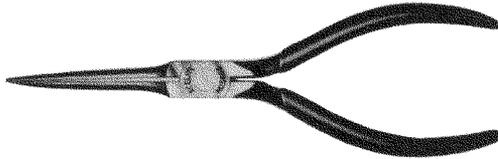
**Fig. 2-3. Long-nose pliers.**
