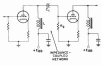
Fig. 12. Impedance-coupled triodes.
