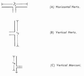
Fig. 9. Hertz and Marconi antennas.
