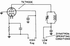
Fig. 19. Dynatron oscillator.
