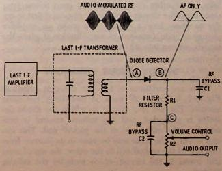
Fig. 6-2. A-m detector circuit.
