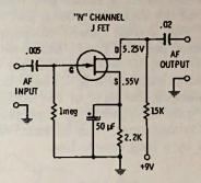
Fig. 16-7. Audio amplifier using JFET.
