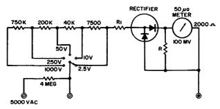
Fig. 1-9. AC-voltmeter configuration.
