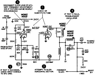
Fig. 4-6. The Synchroguide circuit.
