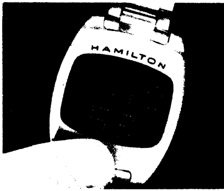
8. ábra. Félvezető karóra, amely gombnyomásra számjegyes formában adja meg a pontos időt. A világ első ilyen órája
