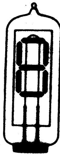
13. ábra A kisfogyasztású, MOS-kombitális fluoreszcens cső felépítése. Több digitális formában is gyártják.
