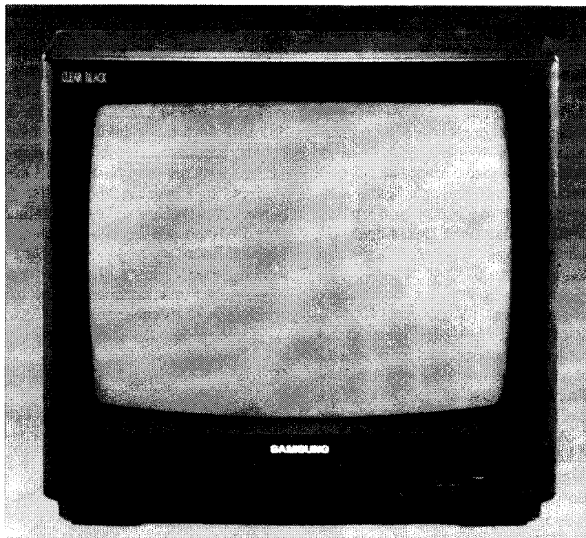
CK-5012 Z51 típusú, negyven csatornás, on-screen kijelzős színes tv vevő
