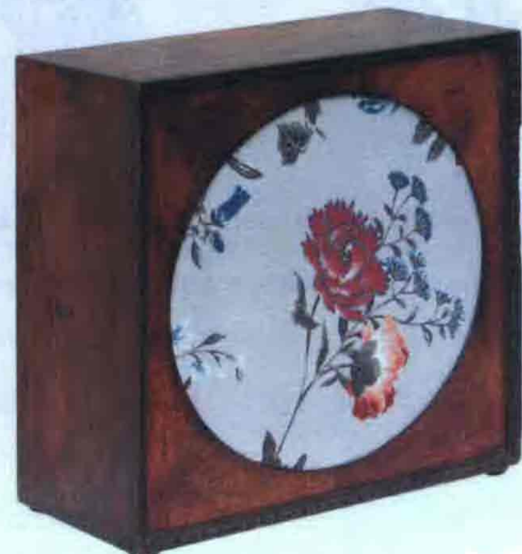
59. kép. Hangszóróselyem pótlása (a szerző gyűjtése)
