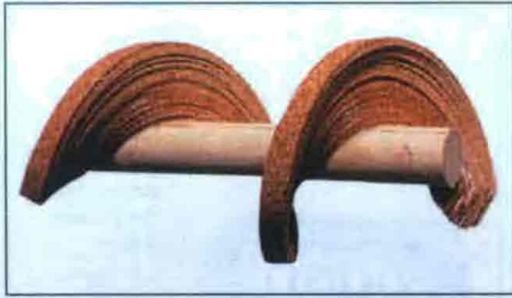
51. ábra. Spirál készítése préselt parafazúzalék-lapból vágott csíkokból
