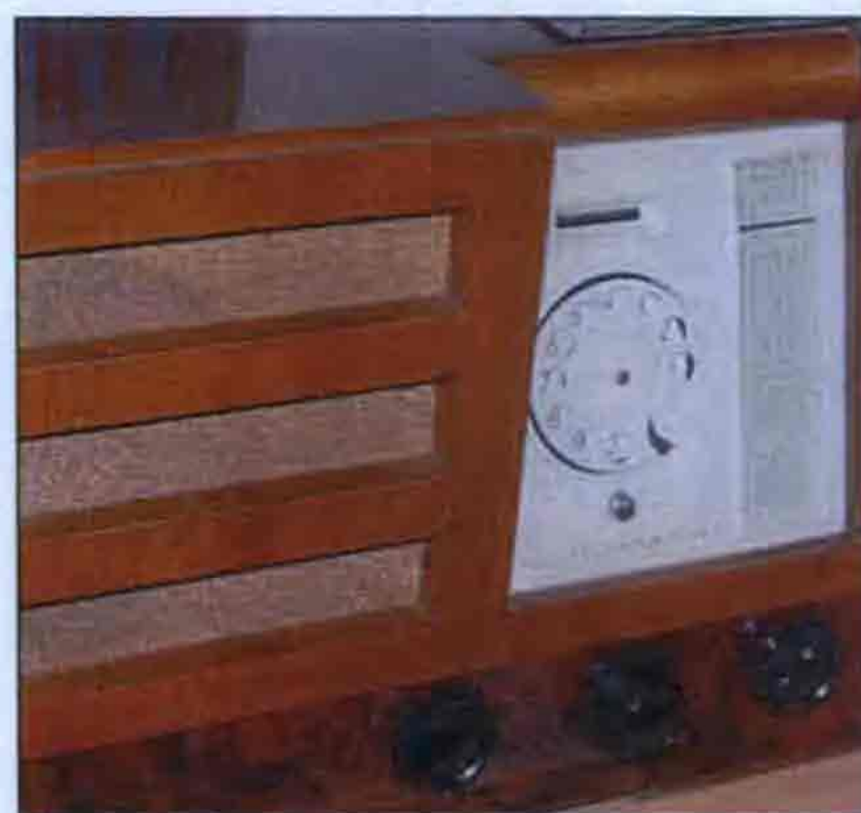
5. ábra. Vezetékes rádióvevő programválasztó számtárcsával
