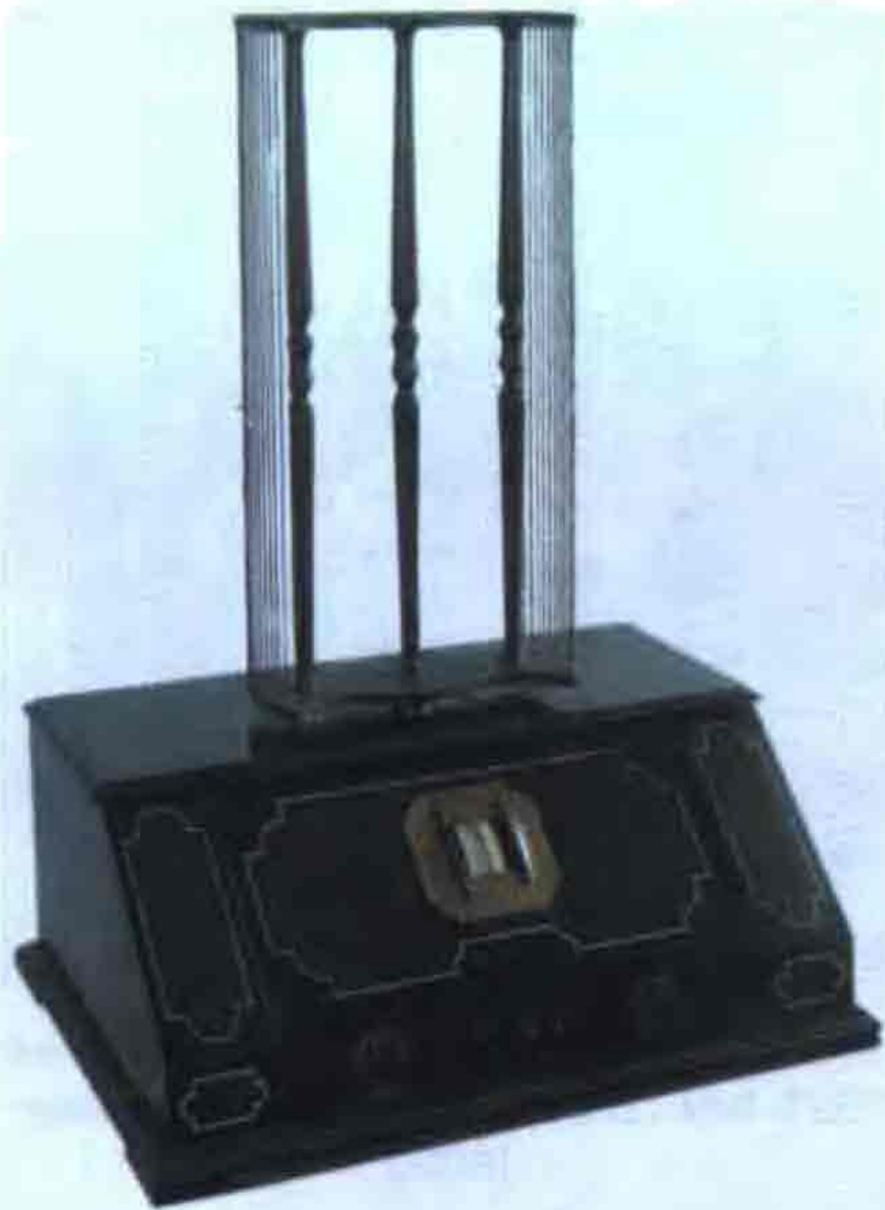
21. kép. RCA Radiola 28 vevő keret-antennával (Háder József gyűjtése)
