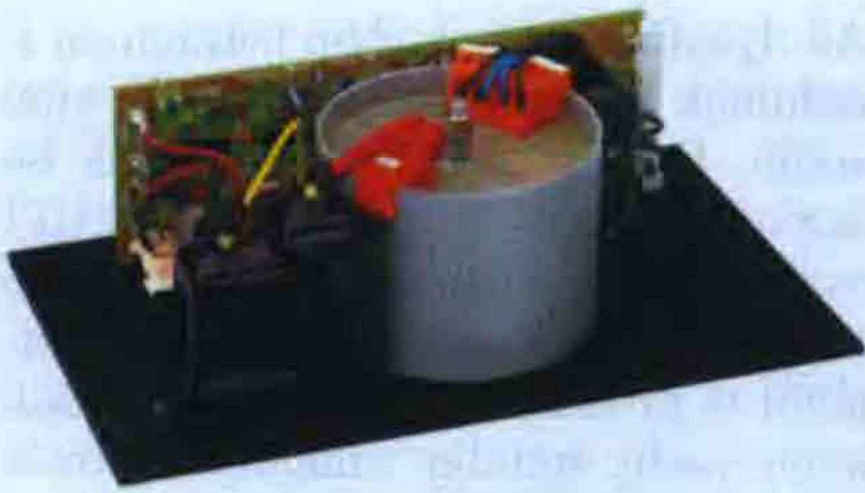
17. ábra. A Monacor SAM-1 típusú, hangsugárzóba beépíthető erősítő belső felépítése
