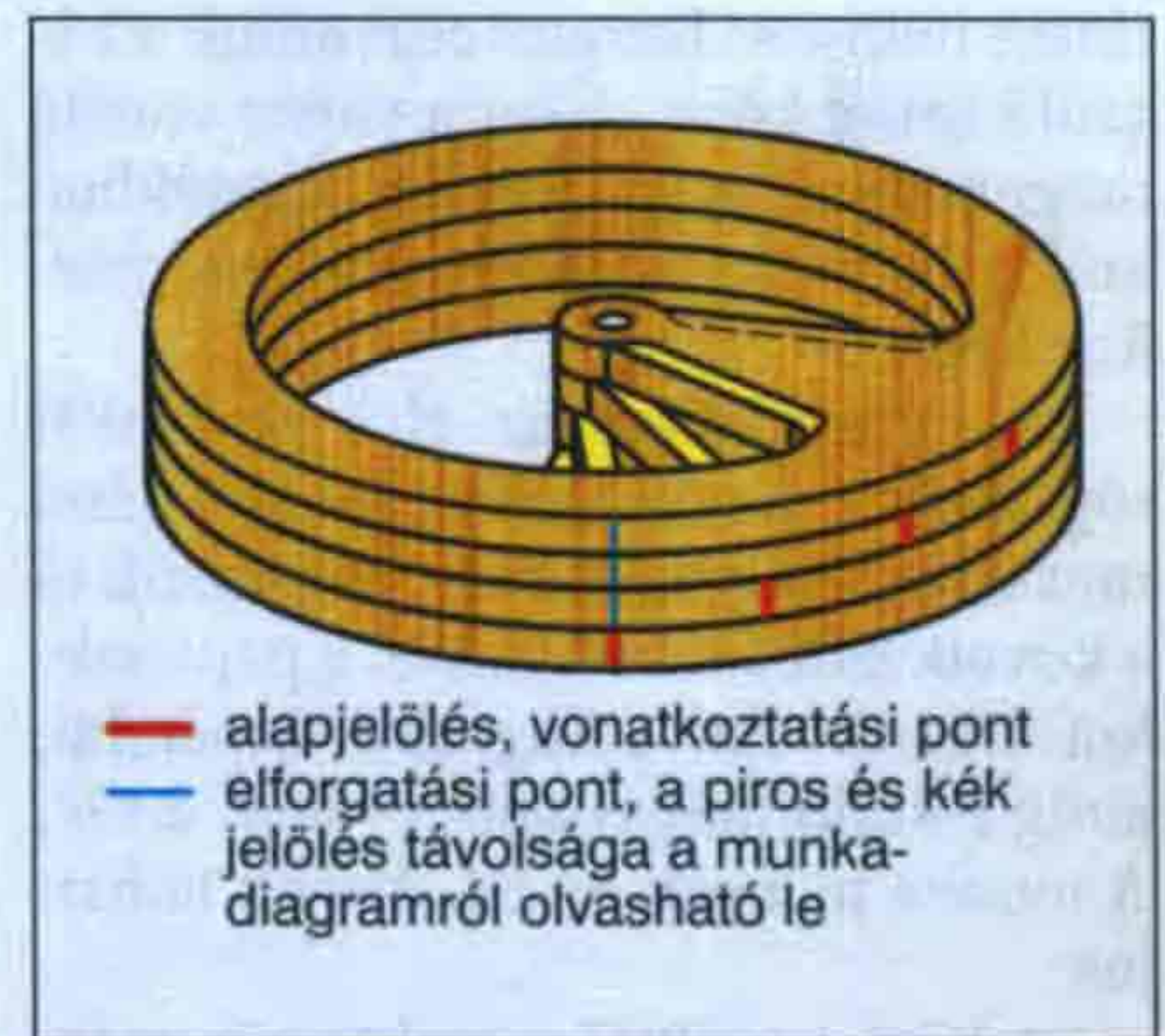
60. ábra. Az egymásra kissé elforgatva rakott, egymáshoz ragasztott karikák alakítják ki a komplett spirált
