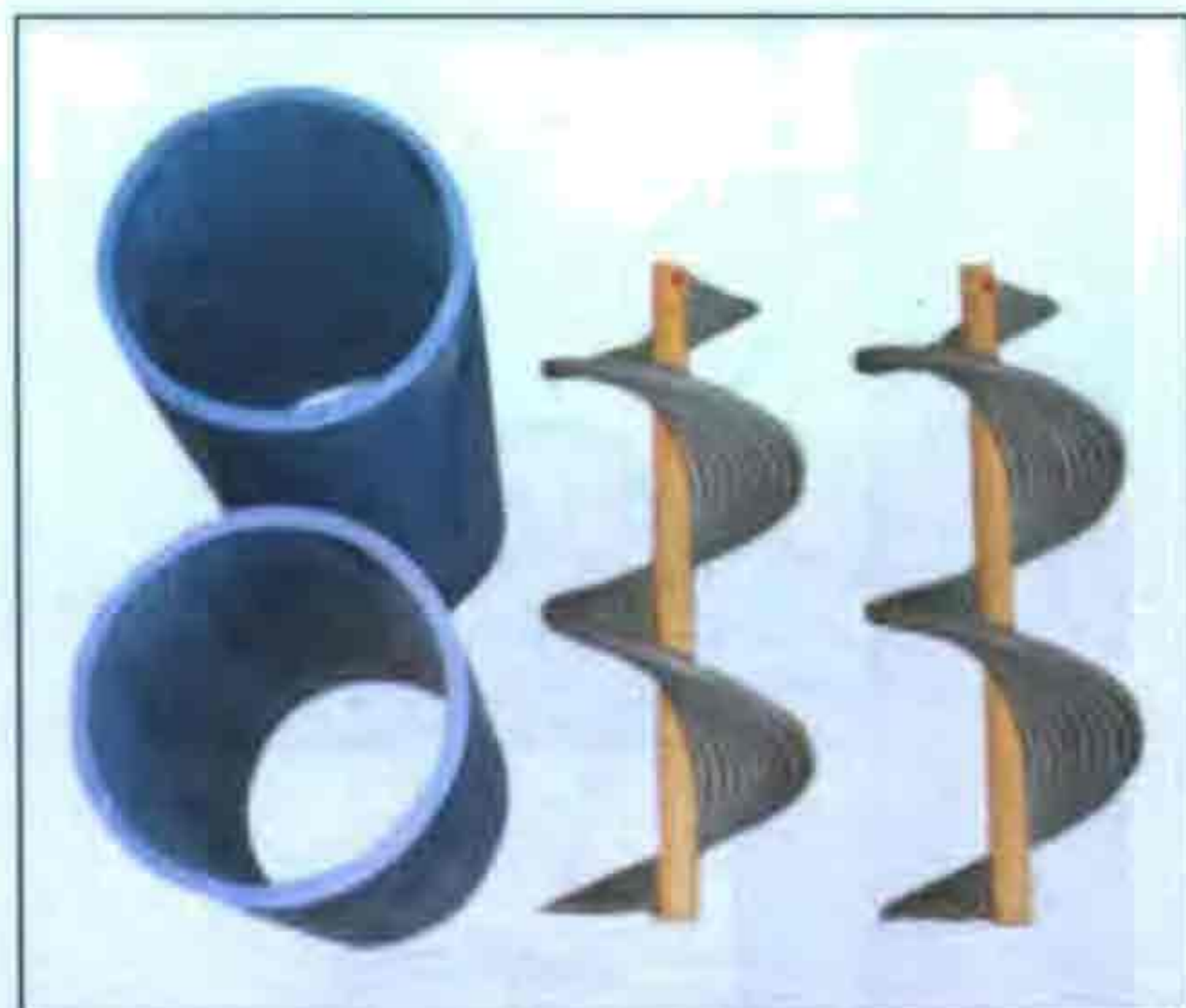
49. ábra. Lapos, kéteres lámpavezetékéből készített spirálok nyers állapotban. A csövekbe ragasztás előtt a spirálvégeket pontosan és merőlegesen méretre kell vágni
