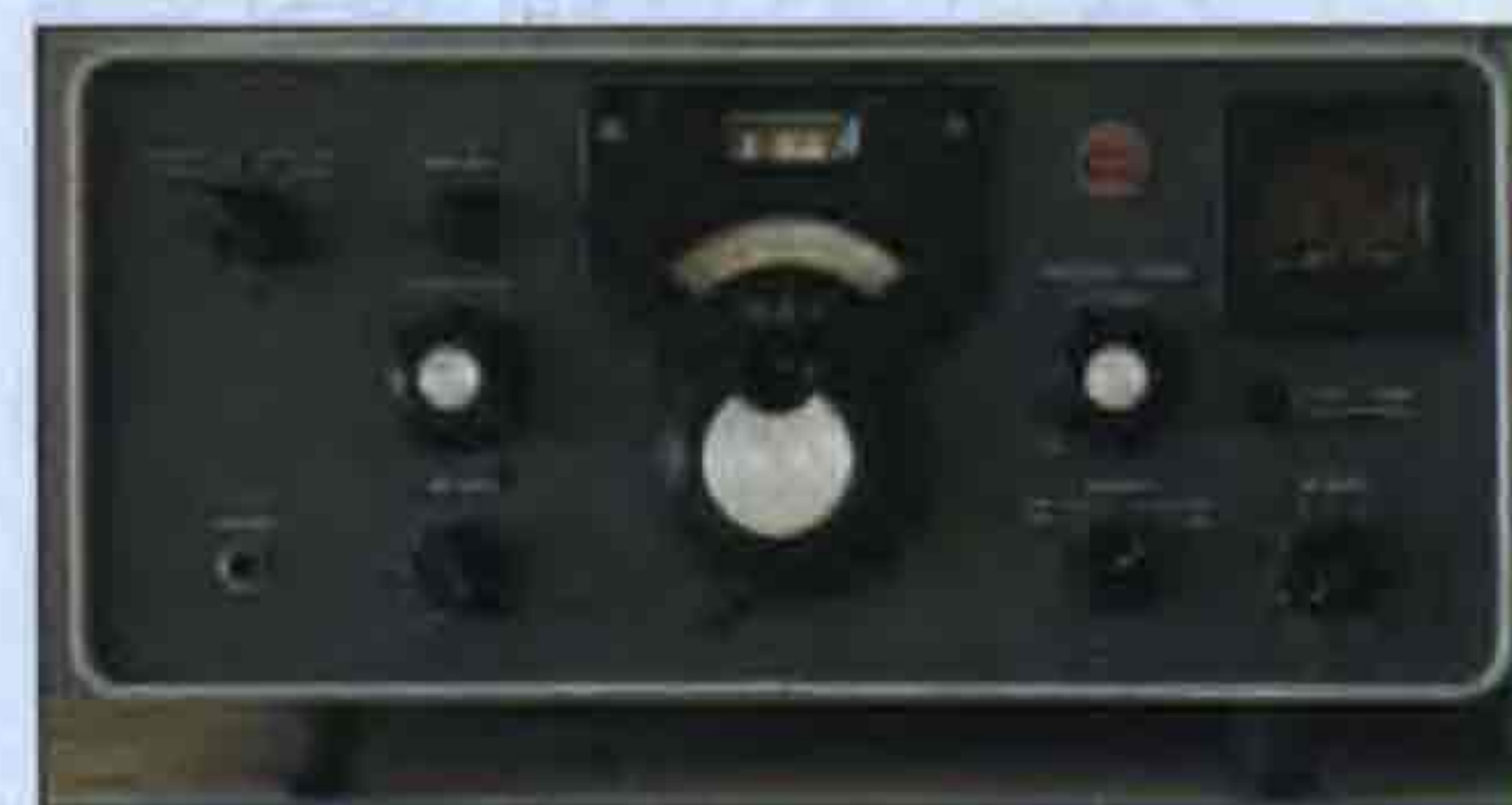
11. ábra. A Collins Radio Co. 51S-1 típusú kettős szupere 1959-ből (200 kHz – 30 MHz; AM, LSB, USB, CW) [www.dr-boesch.ch/radio/]
