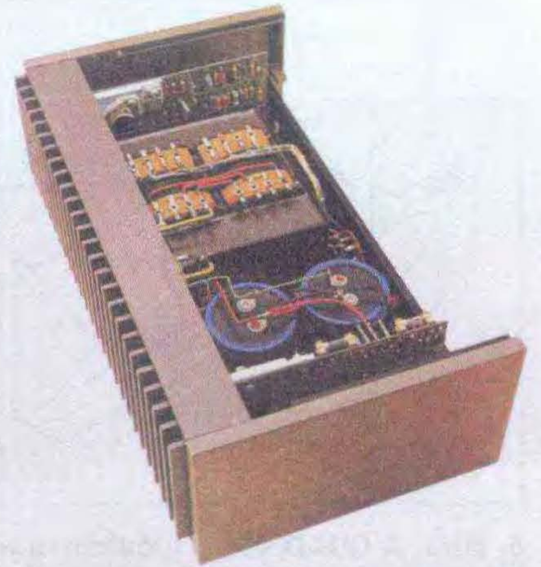
4. ábra. A QUAD 405-1 erősítő példás belső elrendezése (QUAD)
