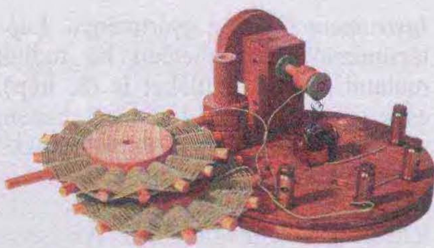
10. kép. MATADOR detektoros (variométeres hangolású) [10]
