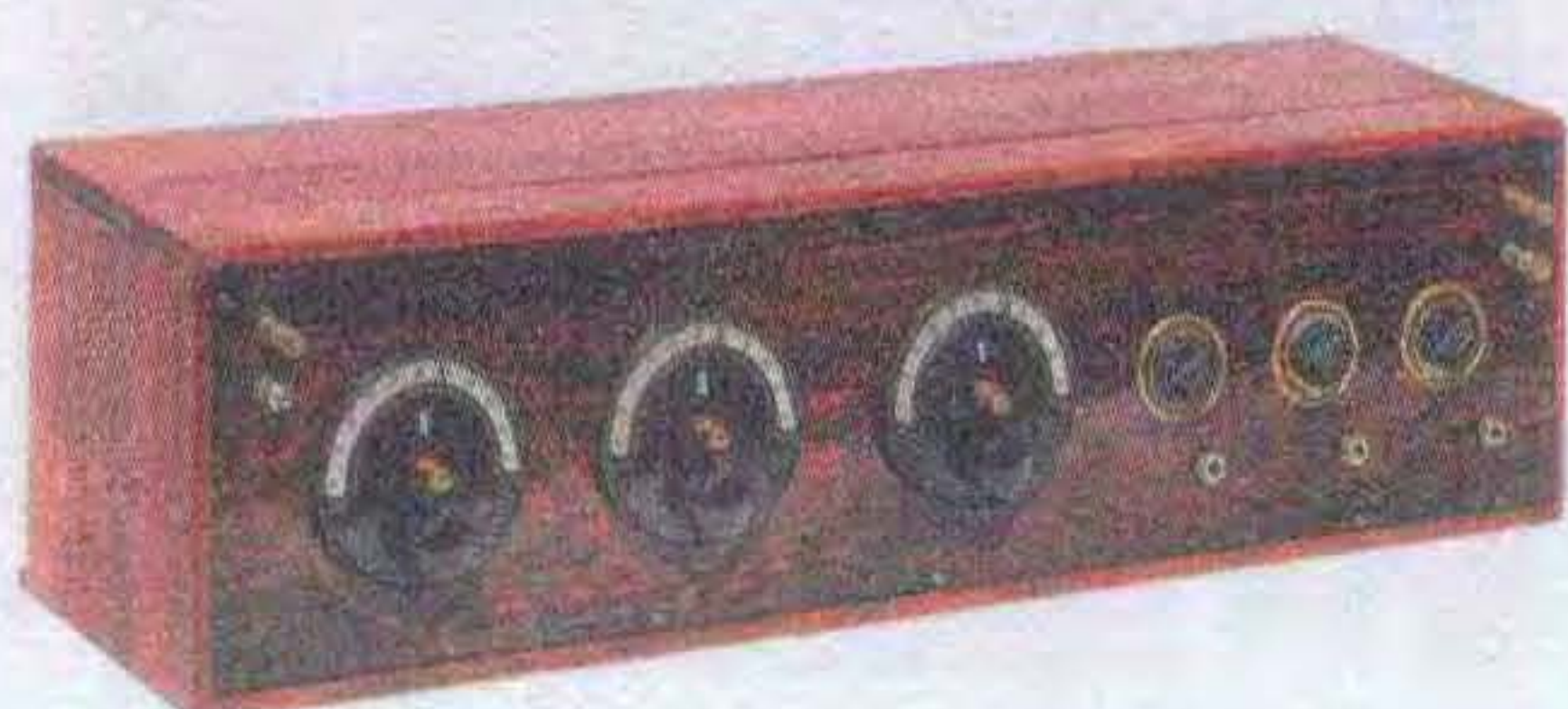
9. kép. Amerikai neutrodyn (Kóger László gyűjtése)
