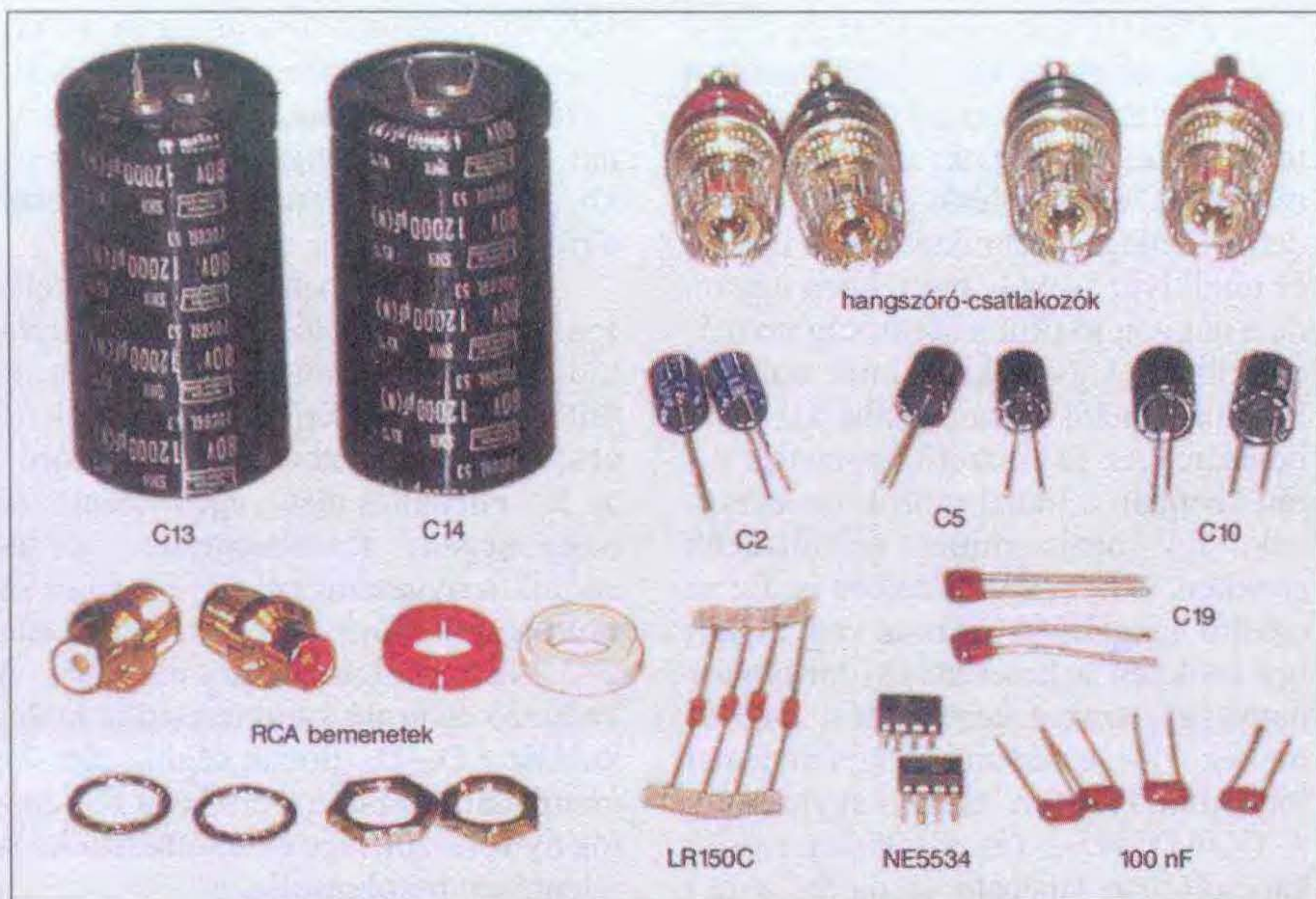
32. ábra. Felújítókészlet a régebbi QUAD 405-ös erősítőkhöz: az elfáradt pufferek pótlására (C13, C14), a kiszáradt kis elkók pótlására (C2, C5, C10), NE5534 az IC1 műveleti erősítő cseréjéhez, az új IC tápfeszültséglábai hidegítéséhez (100 nF, C15, C16), az IC megemelt tápfeszültségéhez 15 V-os Z-diódák (LR150C, D1, D2), T10 esetleges lassítására C19 1 nF kerámiakondenzátor, aranyozott bemeneti RCA-csatlakozók a régi DIN csatlakozó kiváltására, csavaros kivitelű hangszórócsatlakozók a régi, rugós típus kiváltására. Számos hasonló összeállítás szerezhető be a neten!
