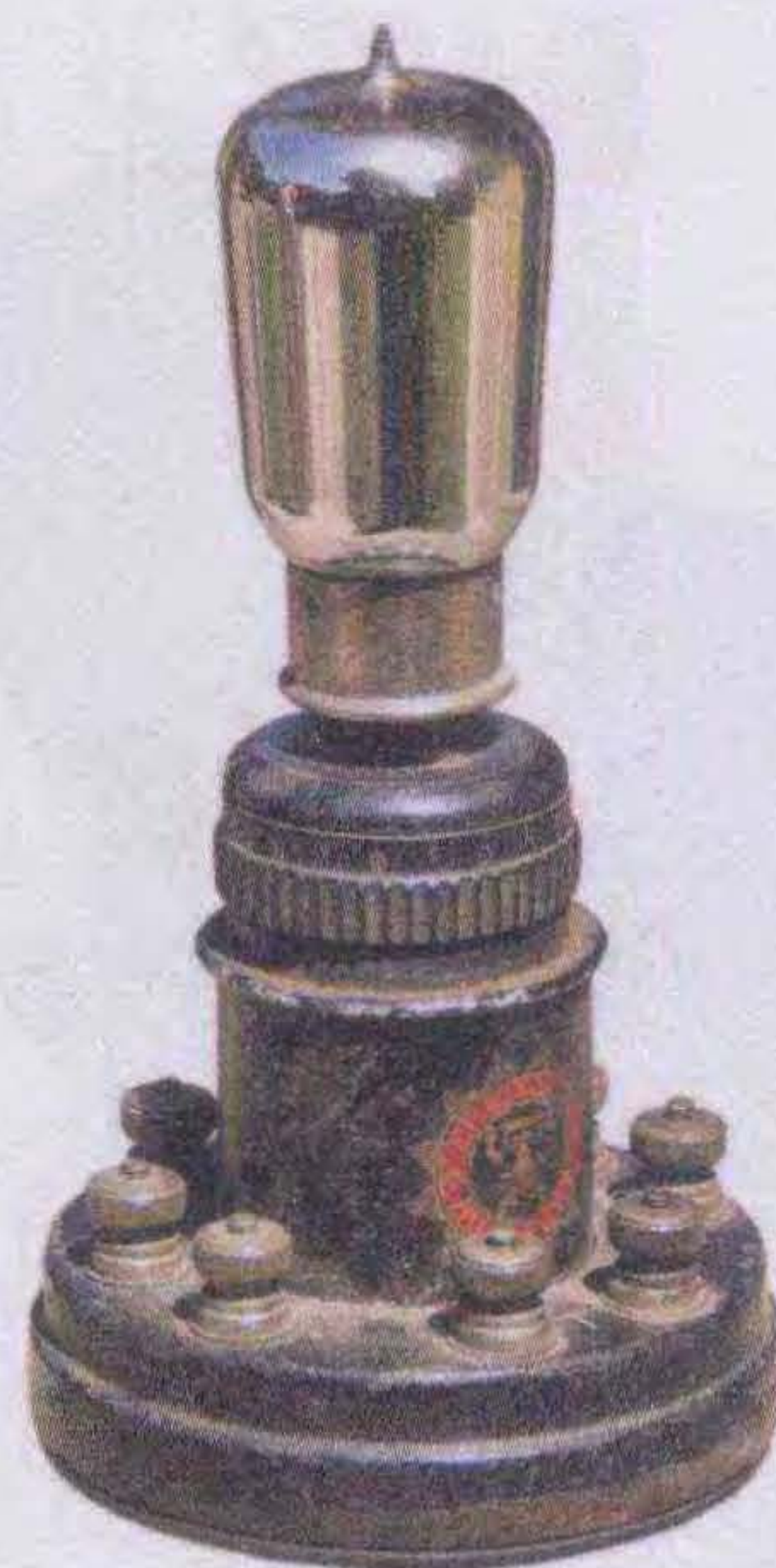
12. kép. Ericsson egycsöves erősítő (Kóger László gyűjtése)
