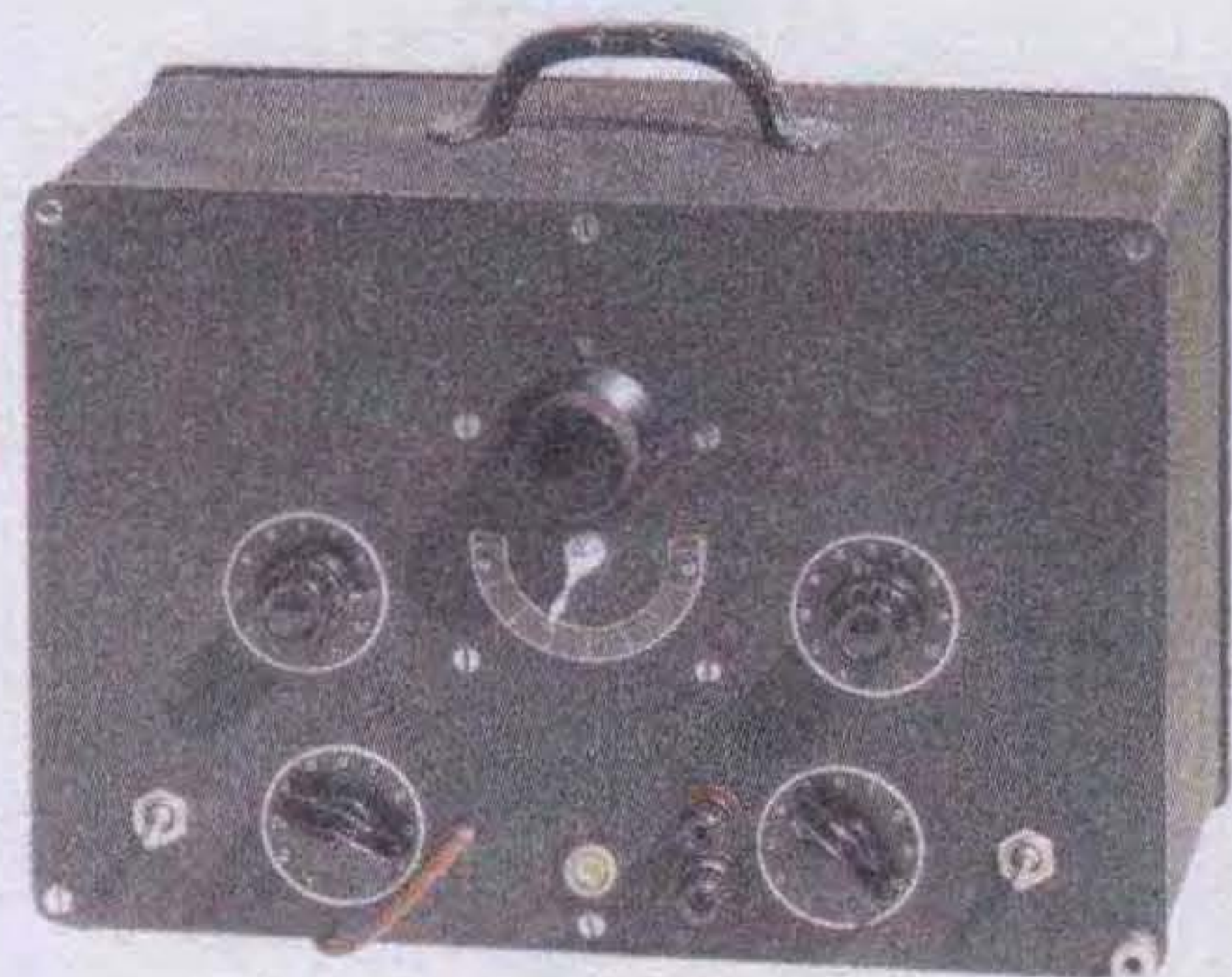
36. kép. Kisipari AM szignál (Asztalos Károly készüléke)
