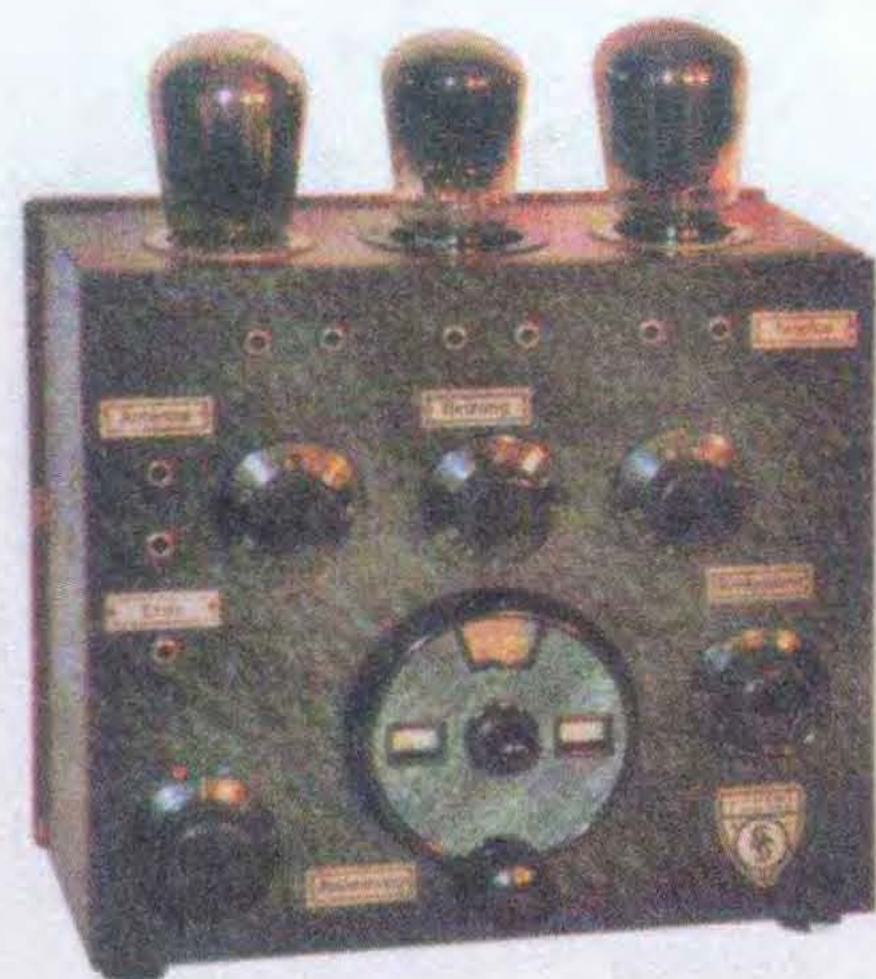
6. kép. Siemens modernizált Rfe 1 [7]
