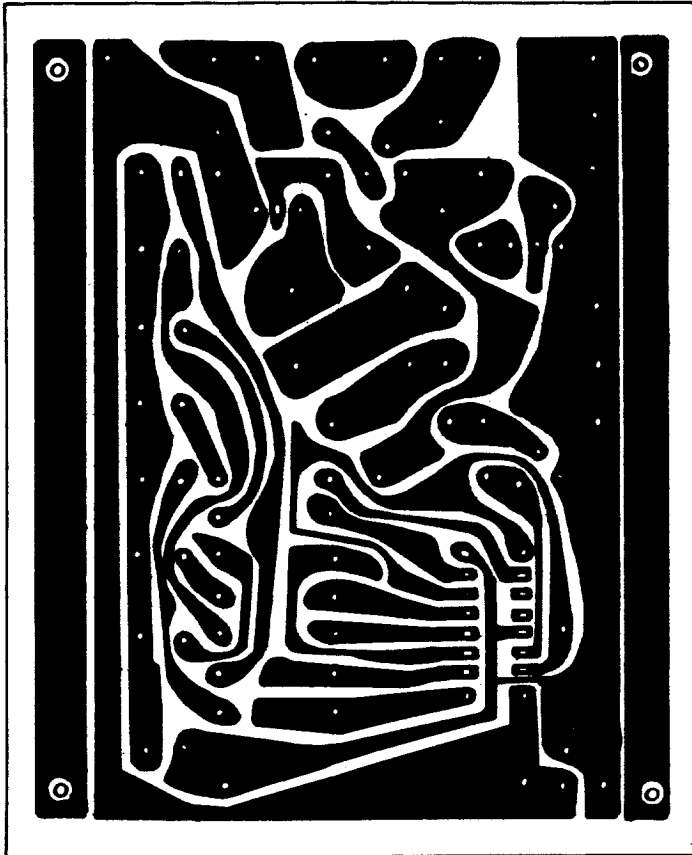
1.20. ábra. „Fénynapítár” a hét napjainak kijelzésére
