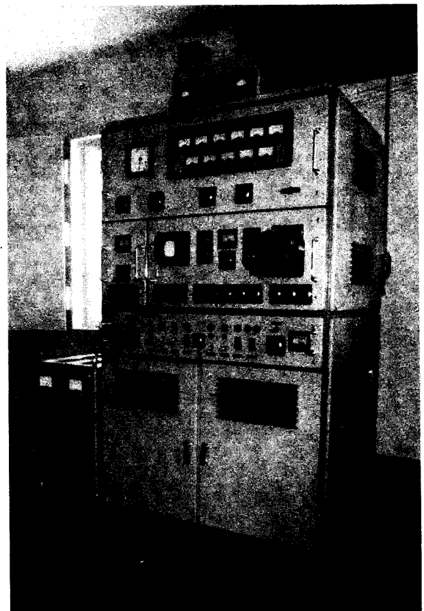
24. ábra. Az 1959-ben megkapott, teljesen automatikus ionoszféra berendezés. Főkonstruktőre: dr. Tófalvi Gyula. Európában több helyütt, rendben tartva, szervizelve, folyamatosan fejlesztve ennél régebbi berendezések működnek még. Nálunk muzeális tárgy lett
