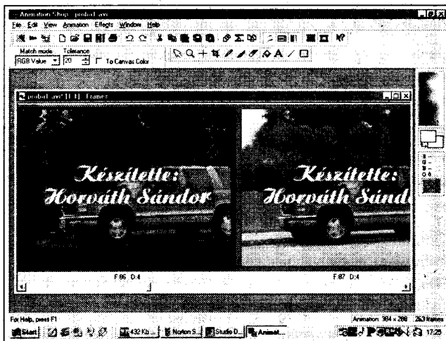
19. ábra. Az Animation Shop programból megnyitottuk az imént készített proba1.avi nevű fájlunkat. Az alsó húzókövel a 86. és a 87. kockát húztuk be a képernyőre. Így áttekinthető az egész film, kockáról kockára. Az animációs program lehetőségei szerint a 86. kockán sötétre festettük a hátteret és a környezetet, ezáltal éjszakai felvétellé alakítottuk azt. Gyakori, hogy közvetlen, intelligens csatolásunk van az ajánlott vagy céges rajzprogramhoz
