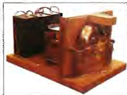
4. ábra. Popov szikratávíró-vevőkészüléke, 1895
