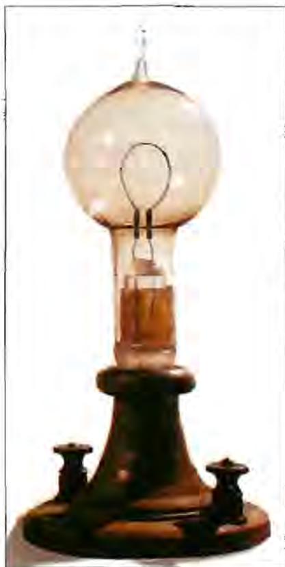
3. ábra. Edison első szénzásalás izzólámpája
