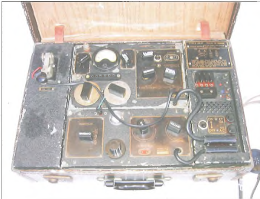
SOE 3 Mk II (B2) rádió. Középen fenn az adó-, alatta a vevőrész, jobbra a tápegység, balra a tartozékok doboza látható, a billentyűvel
