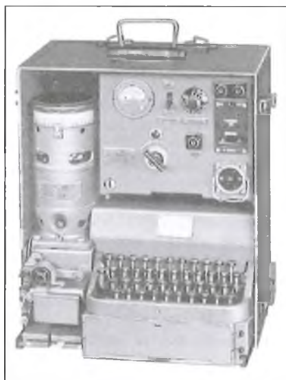
1. ábra. Hordozható Siemens-Hell-Feldschreiber, működtetésre kész állapotban. (Hell Technische Mitteilungen, Mai 1940. H. 1, S. 12.)
