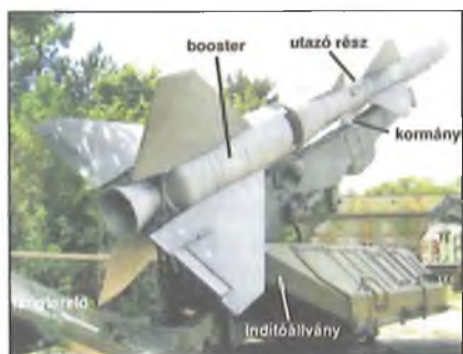
18. ábra. Sz-75 Dvina légvédelmi rendszer kétfokozatú rakétája az indítóállványon (Zsámbék)
