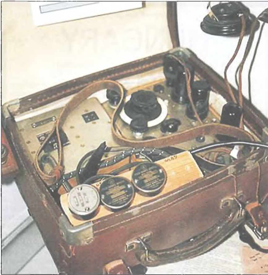
Paraset bőrönd adó-vevő. Jobbra fenn a vevő csövei, ill. az adó elektroncsöve, alul a tartóban 3 db adókristály, balra a tápegység látható
