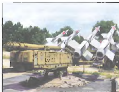
19. ábra. Az SzNR-125 Nyeva rendszer szilárd hajtóanyagú, kétlépcsős rakétái az indítóállványon (Zsámbék)
