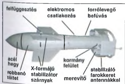
10. ábra. Fritz-X, a rádióvezérlésű, intelligens páncéltörő bomba (1944)
