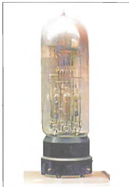
5. ábra. Loewe-Ardenne 3NF típusú háromszorosan összetett csöve. ( www.hts-homepage.de/TechnischesMuseum/ alapján)
