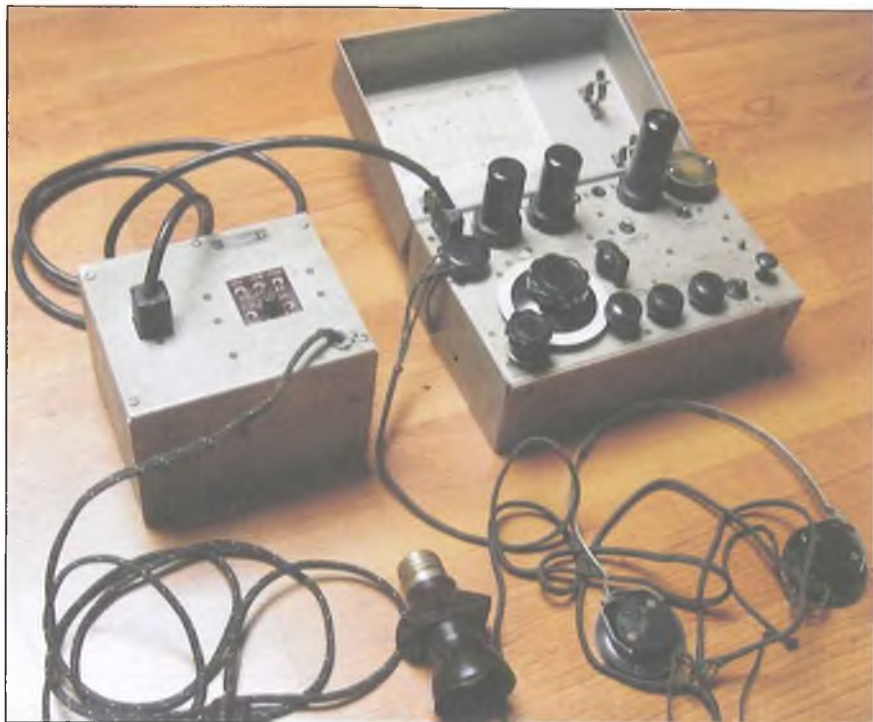
A Paraset adó-vevő részének fedelében levő diagramról lehetett leolvasni a lineáris skálához (fehér tárcsa) tartozó vételi frekvenciát
