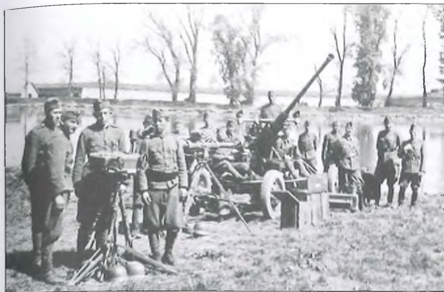
3. ábra. Magyar légvédelmi üteg a II. világháborúból. Balra a Juhász-Gamma féle löelemképző, kezelőivel, hátrébb a háromlábbon egy könnyű optikai távmérő, jobbra egy légvédelmi gépágyú és kezelő személyzete
