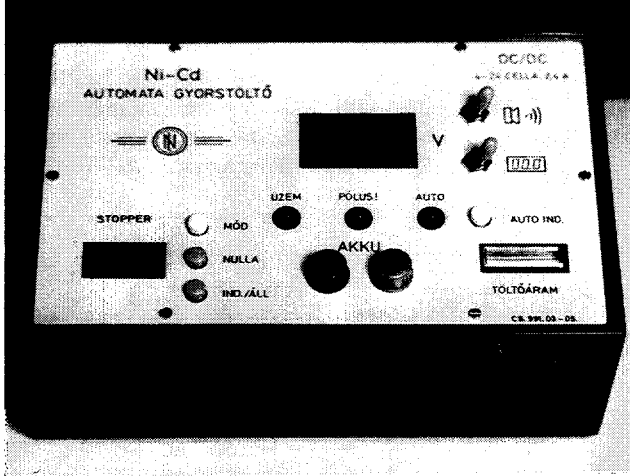
A DC/DC automata gyorsító fotói
