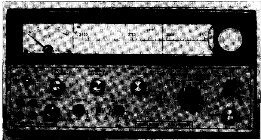
1. ábra. A 20 W-os adó-vevő előlnézeti képe
